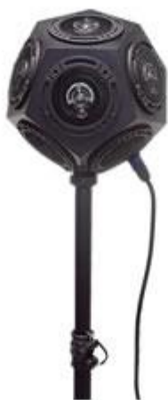
Figura 5 - Fonte Sonora Omnidirecional Dodecaédrica Fonte: GROM 2016
