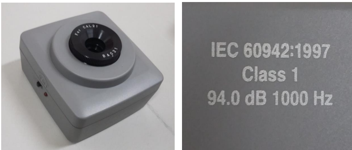
Figura 34 - A: Calibrador CAL 21; B: Detalhe Calibrador Fonte: Autoria própria
