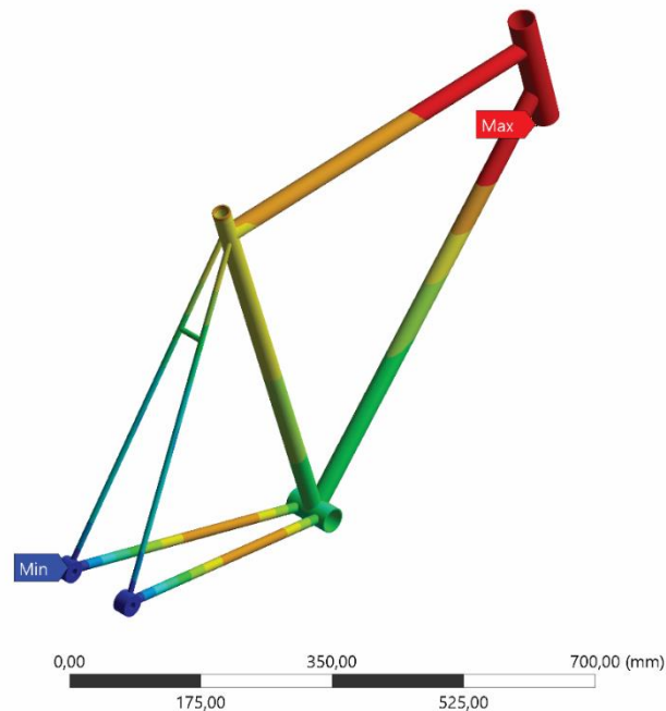
Figura 27 - Locais de deformação máxima e mínima Fonte: autoria própria
