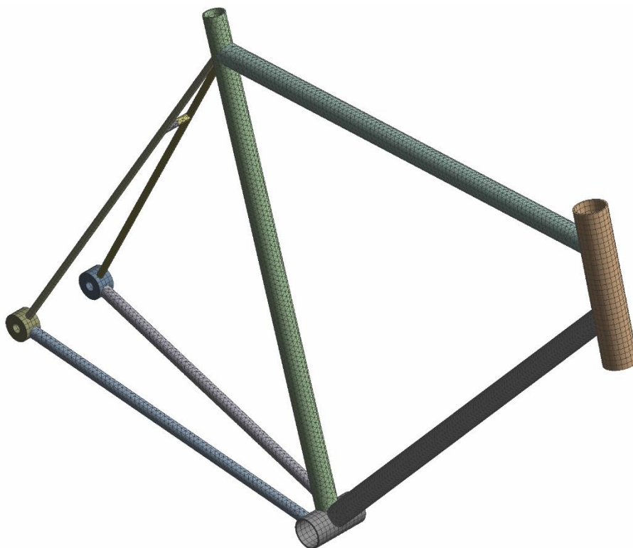
Figura 22 - Malha gerada em um dos quadros Fonte: autoria própria
