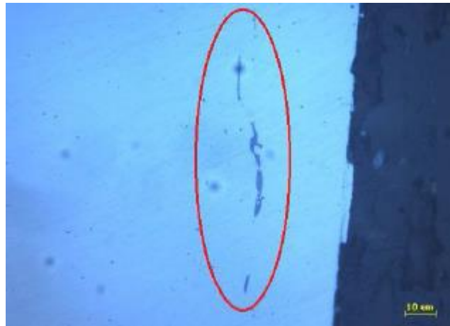
Figura 29 - Inclusões de MnS Fonte: Autoria própria (2016)
