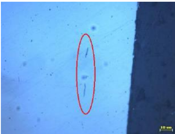
Figura 30 - Inclusões de MnS Fonte: Autoria própria (2016)
