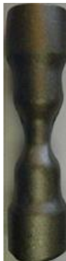
Figura 19 - Pré-forma após passar pelo processo de laminação em rolos Fonte: Figura interna da Empresa X
