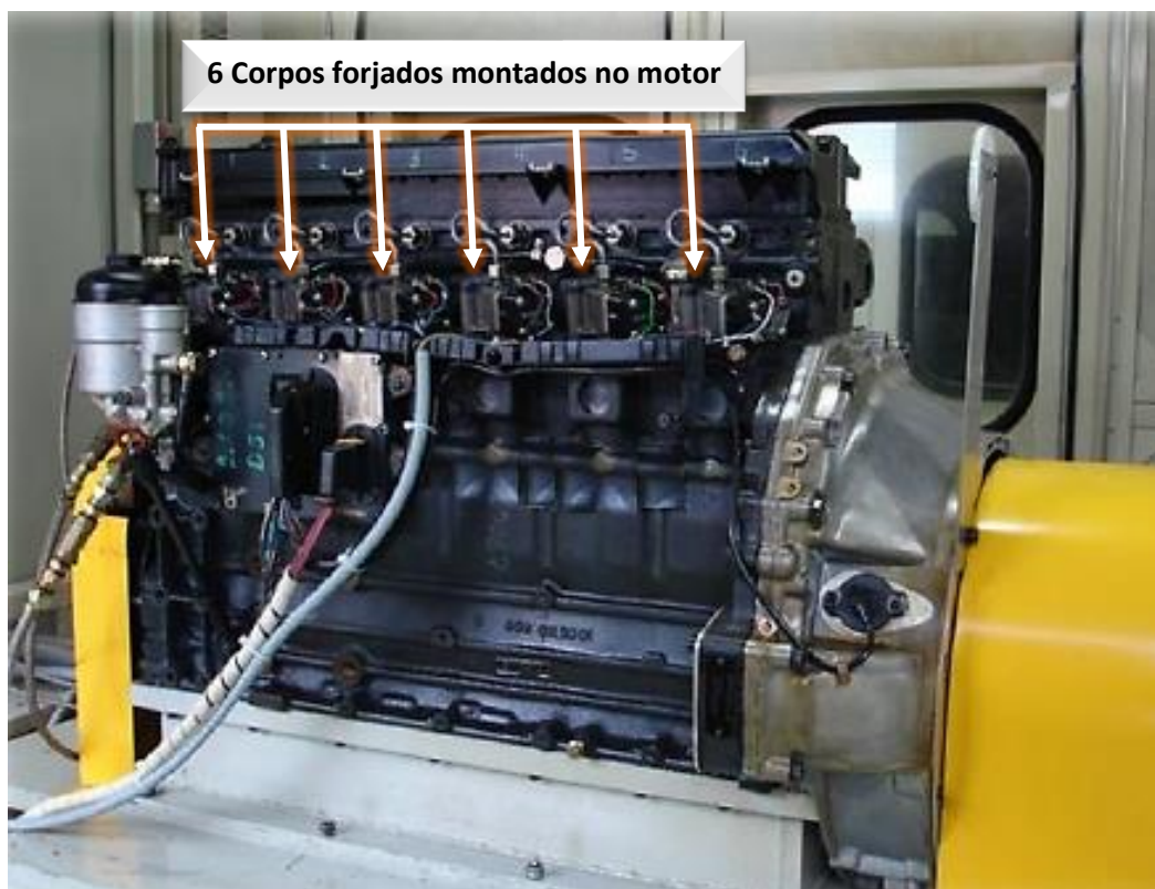
Figura 23 - Motor ciclo diesel do teste de pulsação hidráulica de alta pressão.
