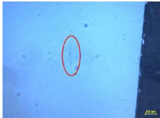
Figura 31 - Inclusões de MnS Fonte: Autoria própria (2016)
