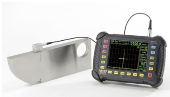
Figura 9 - Exemplo de equipamento de ultrassom utilizado na indústria Fonte: Multiflux
