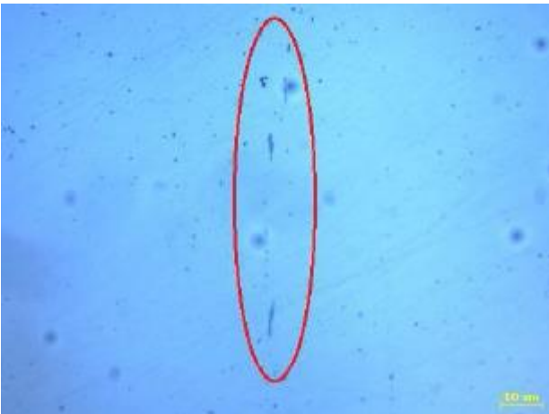
Figura 28 - Inclusões de MnS Fonte: Autoria própria (2016)
