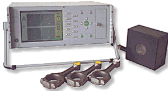
Figura 11 - Equipamento utilizado para executar o ensaio não destrutivo por correntes parasitas Fonte: Arotec Indústria e Comércio
