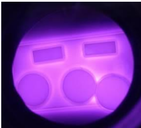
Figura 4.4 - Bainha catódica formada durante o processo de nitretação.
