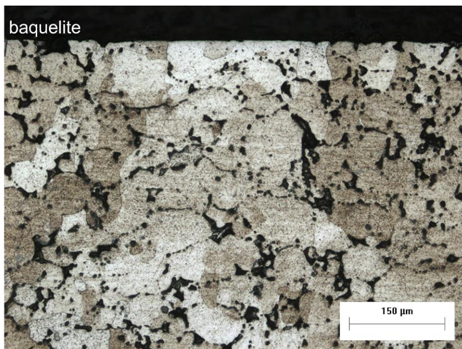
Figura 5.3 – Metalografia amostra Y sinterizada
