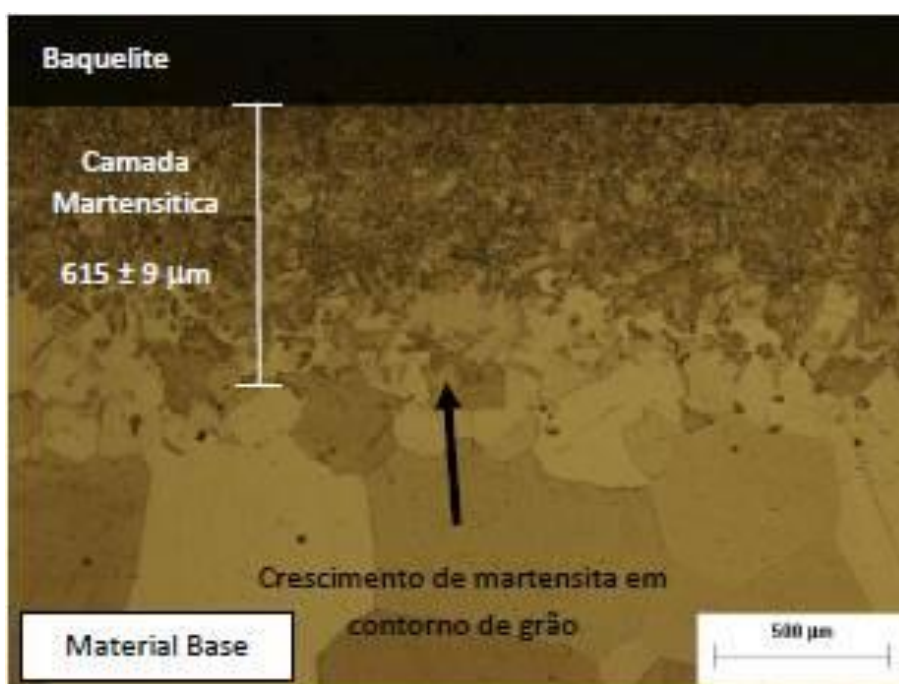
Figura 3.4 - Martensita de nitrogênio obtida através do SHTPN
