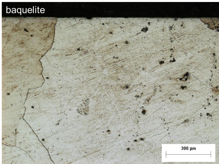
Figura 5.1 – Metalografia amostra IF no estado de fornecimento
