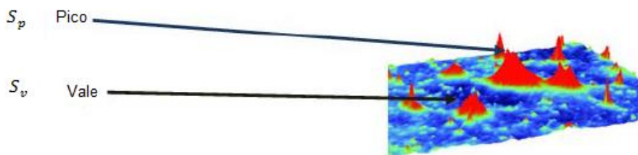
Figura 2.9 - Representação da rugosidade máxima S_z .
