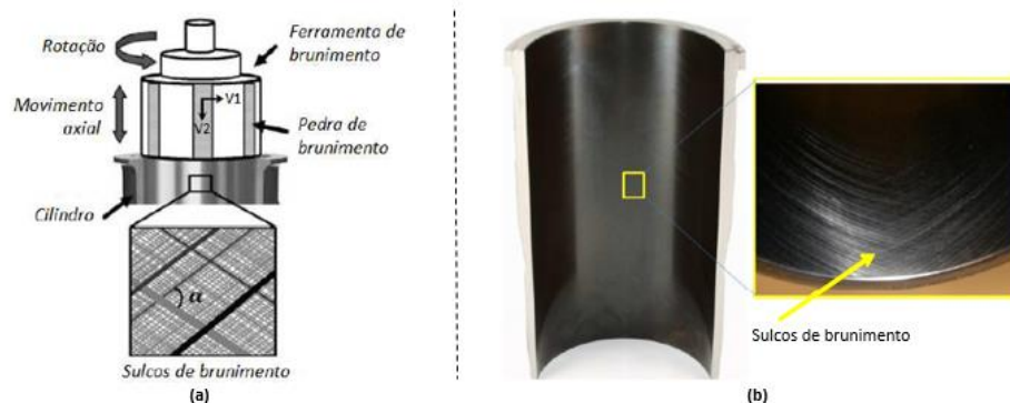
Figura 2.2 - (a) Representação esquemática do brunimento de cilindros/camisas de cilindros; (b) Superfície brunida de uma camisa de cilindro.
