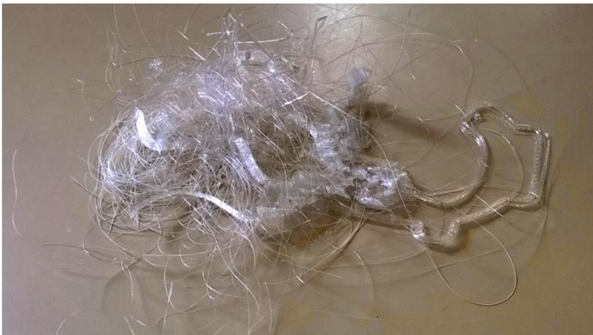
Figura 3 – Material polimérico desperdiçado devido descolamento da peça. Fonte – Autoria própria 1
