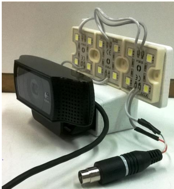
Figura 35 – Câmera e módulo de led presos ao suporte.
