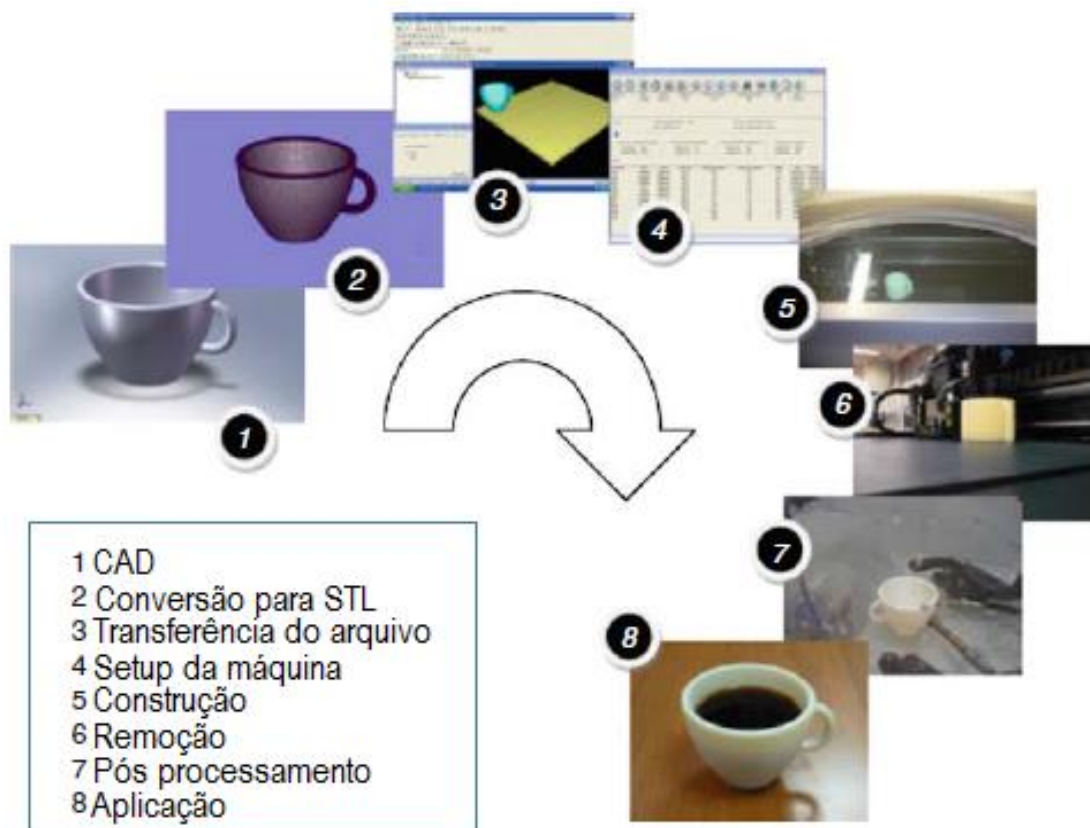
Figura 5 – Processo genérico do CAD à peça em 8 etapas.
