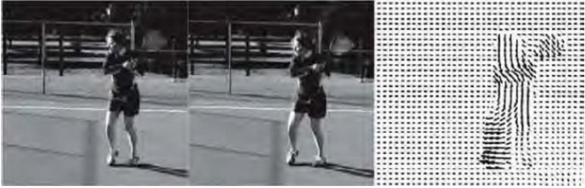
Figura 16 – Fluxo óptico extraído de duas imagens de um vídeo com movimento.
