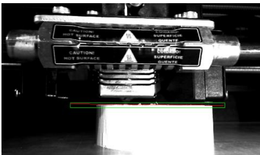
Figura 42 - Impressão com baixo acabamento superior.
