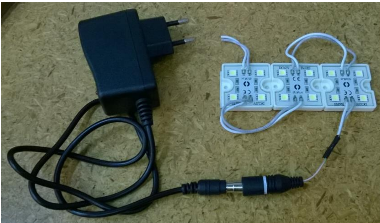
Figura 20 - Módulo led smd5050 ligado à fonte de alimentação.
