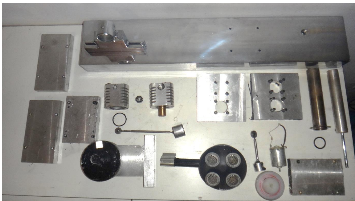
Figura 19 - Conjunto de peças e submontagens utilizadas para funcionamento do motor Stirling tipo gama
