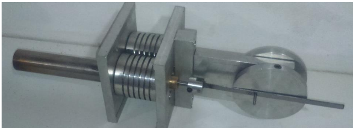
Figura 9 - Motor stirling tipo gama testado pela primeira vez.
