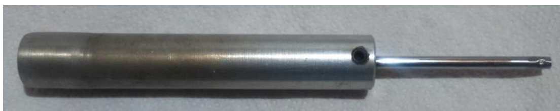
Figura 10 – Montagem do cilindro deslocador e a haste de aço, ambos utilizados para fabricação do motor Stirling tipo gama
