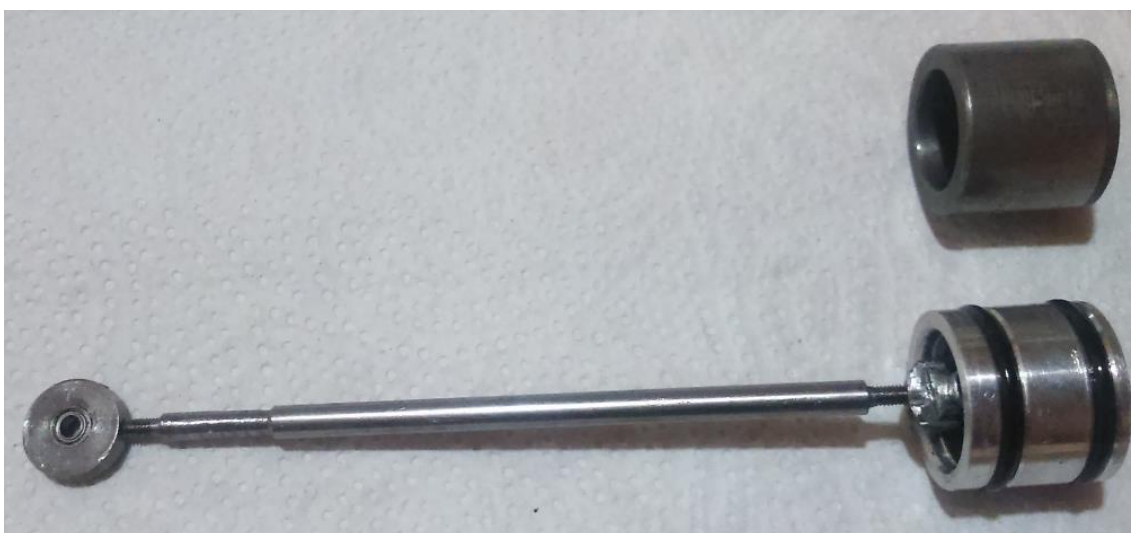
Figura 15 - Pistão de potência feito inicialmente utilizando ferro fundido e posteriormente utilizando alumínio com vedação de anel O'ring de tamanho número 13.
