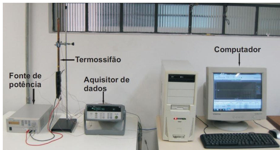
Figura 4-1 Bancada experimental para um termossifão com condensador arrefecido por convecção forçada a ar
