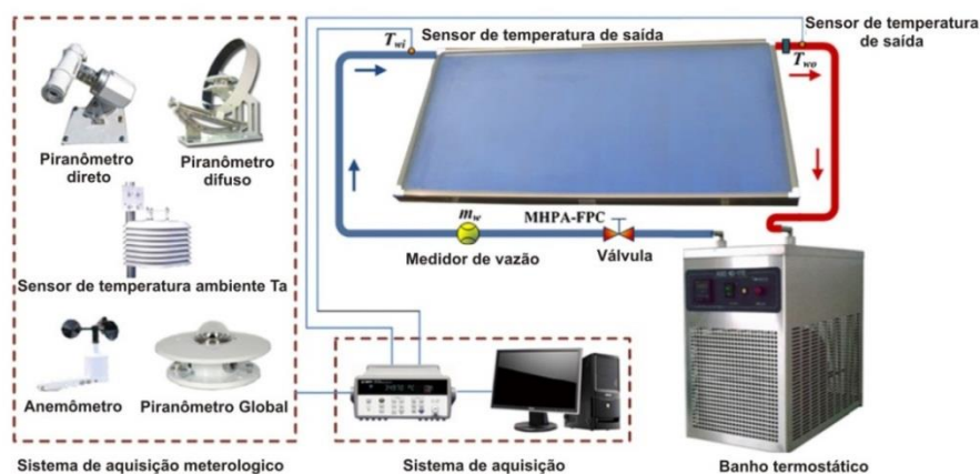
Figura 2-11 Sistema experimental do coletor solar com matriz de micro tubos de calor Fonte: Modificado Deng et al, (2013)
