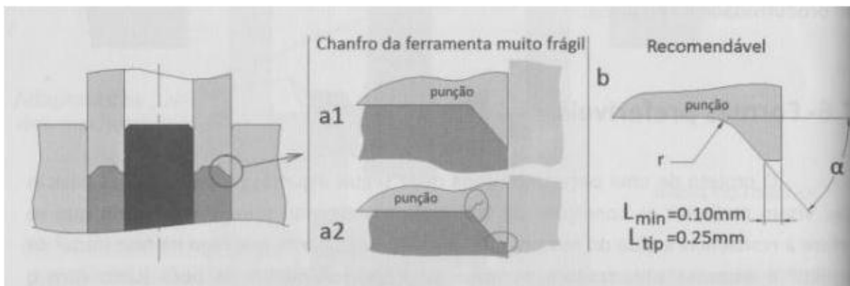
Figura 12: A figura “a1” mostra um chanfro não adequado ao processo de compactação, e a figura “a2” a falha que ocorre em um chanfro como este. A figura “b” apresenta as recomendações a serem adotadas, onde 30^\circ é o valor ideal para \alpha .
