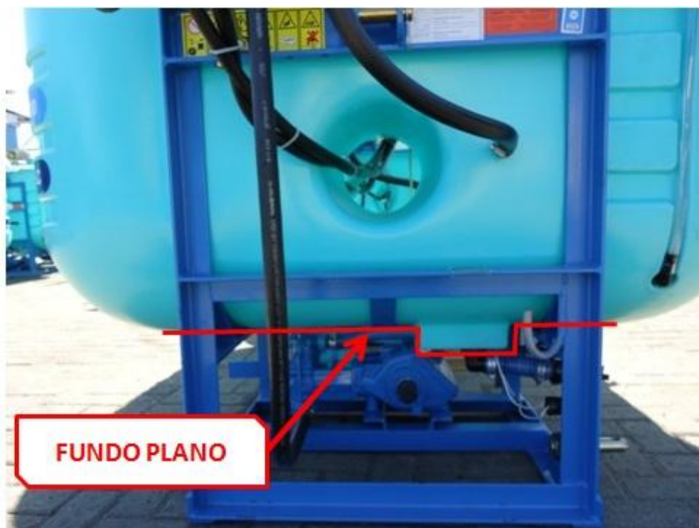
Figura 48 – Detalhe do fundo plano do tanque de pulverização
