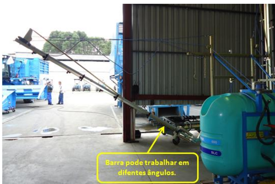
Figura 32 – Inclinação da barra de pulverização
