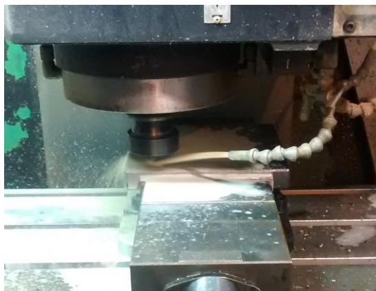
Figura 15 – Atuação do fluido refrigerante Fonte: Autoria própria.
