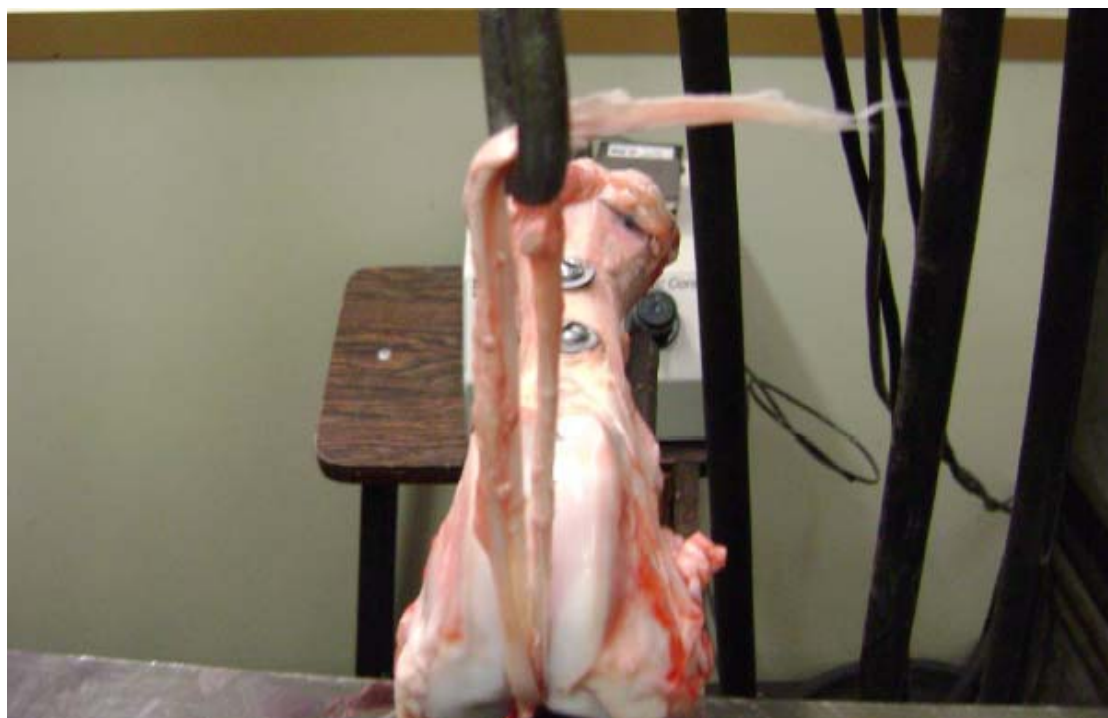
Figura 33 - Enxerto com uma das 4 abas rompidas
