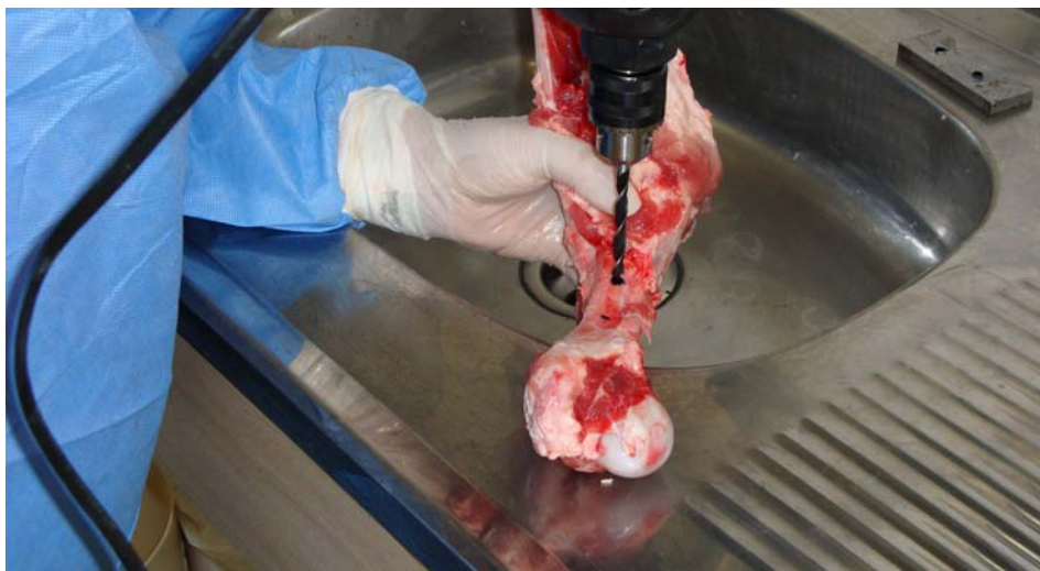
Figura 24 – Realização dos furos para fixação do osso na máquina de ensaios
