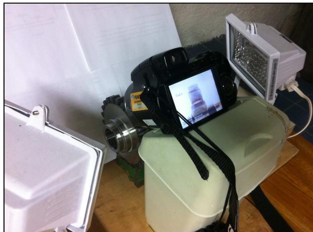
**Figura 31 – Sistema fotográfico utilizado para aquisição das imagens dos dentes**
