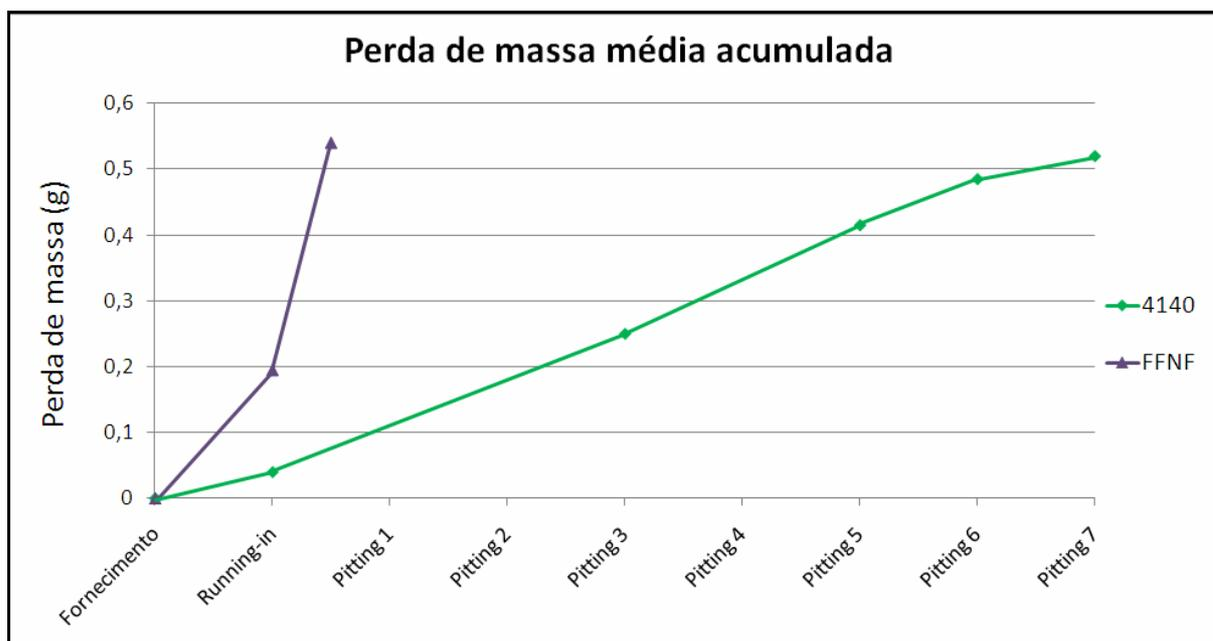
Figura 41 – Perda de massa média acumulada ao longo dos ensaios, do FFNF e do aço ABNT 4140
