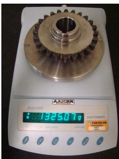
Figura 30 – Medição de massa de uma engrenagem de aço ABNT 4140
