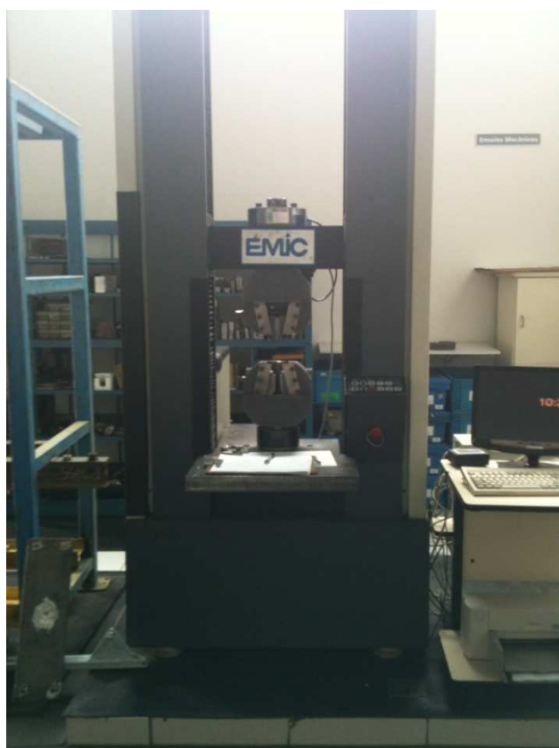
Figura 17 - Máquina Universal de Ensaio de Tração, marca EMIC, modelo DL30000.
