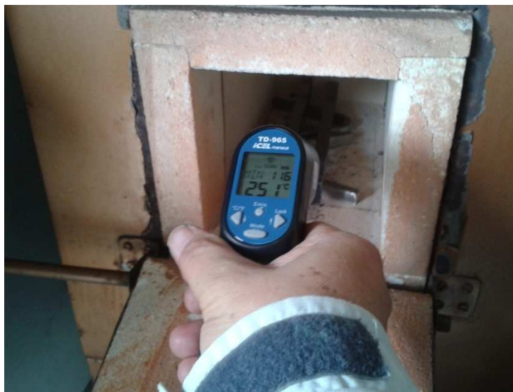
Figura 18 – Temperatura dos corpos de prova em forno para envelhecimento.
