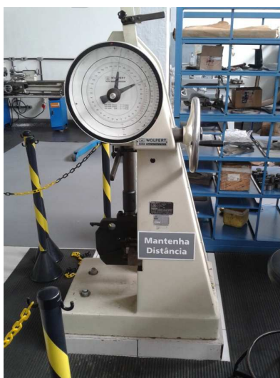
Figura 23 - Máquina universal de ensaio de impacto, marca AMSLER, modelo D-6700
