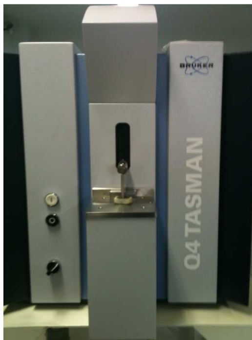
Figura 7 - Espectrômetro BRUKER utilizado para análise química, instalado na Spectroscan.
