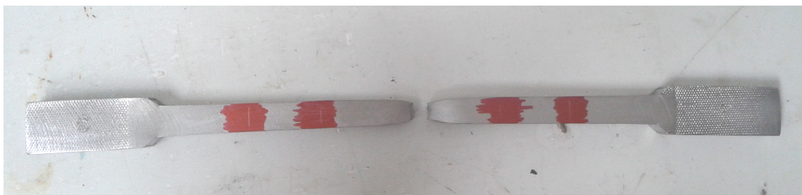
Figura 27 - Corpo de prova 3 após ensaio de tração até ruptura
