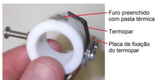
Figura 3-9 - Detalhes do corpo com adaptação do termopar para medição da temperatura no contato: fotografia da montagem do termopar no corpo
