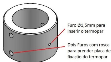
Figura 3-8 - Detalhes do corpo com adaptação do termopar para medição da temperatura no contato: vista em perspectiva com detalhes acrescidos
