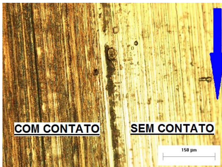
Figura 4-13 - Contra corpo de aço inoxidável, limite da área de contato (o sentido de deslizamento é indicado pela seta azul)
