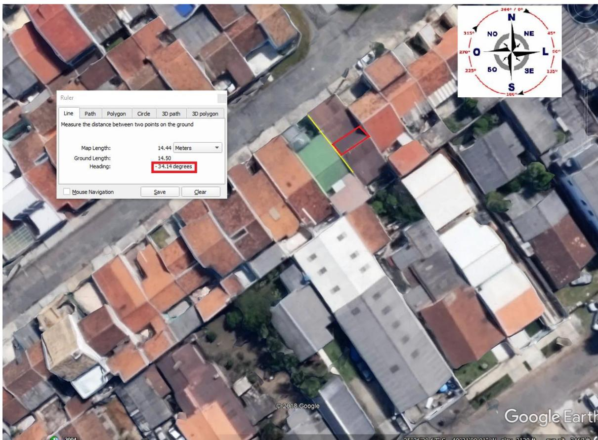
**Figura 22 – Ângulo do desvio azimutal do telhado da residência.**
