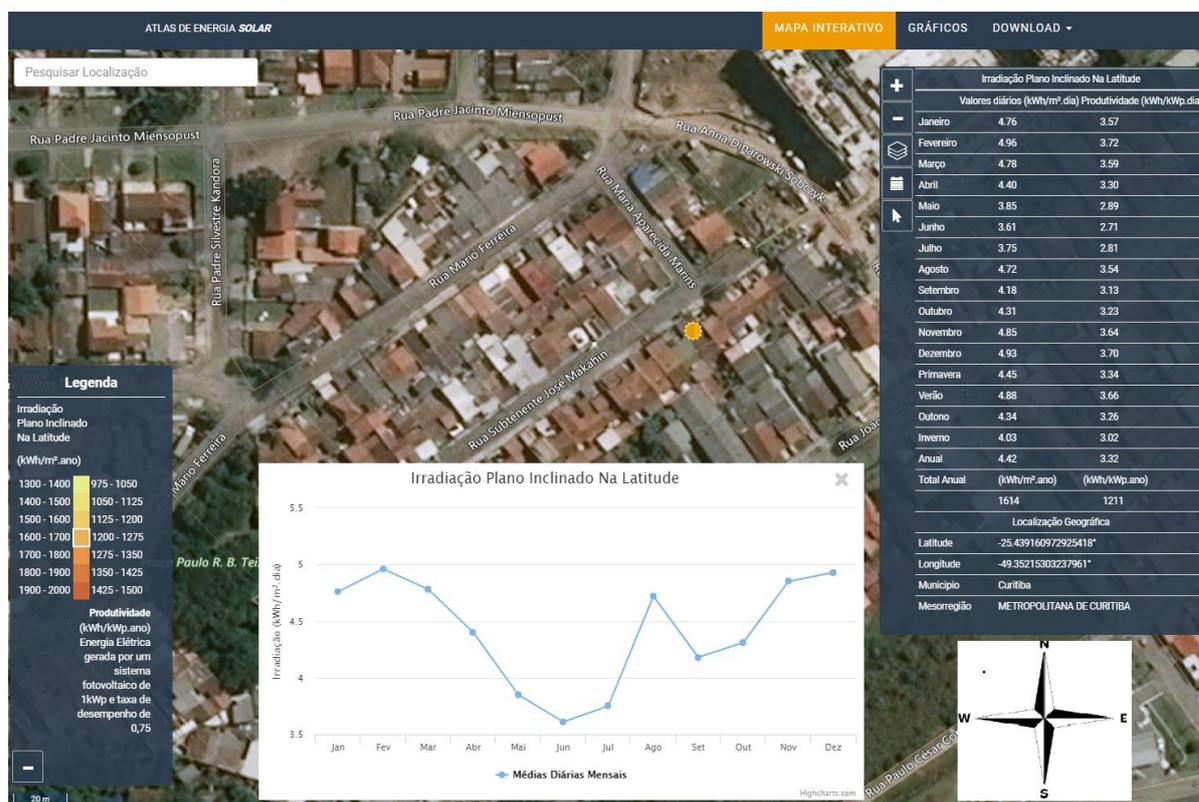
Figura 26 – Irradiação no plano inclinado na latitude na área da residência.
