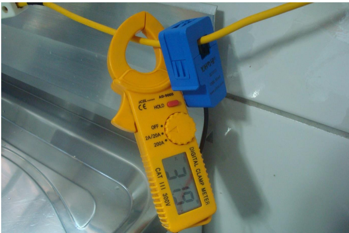
Figura 51: Amperímetro alicate CAT junto com o sensor de efeito Hall do equipamento. Fonte: Autoria própria.
