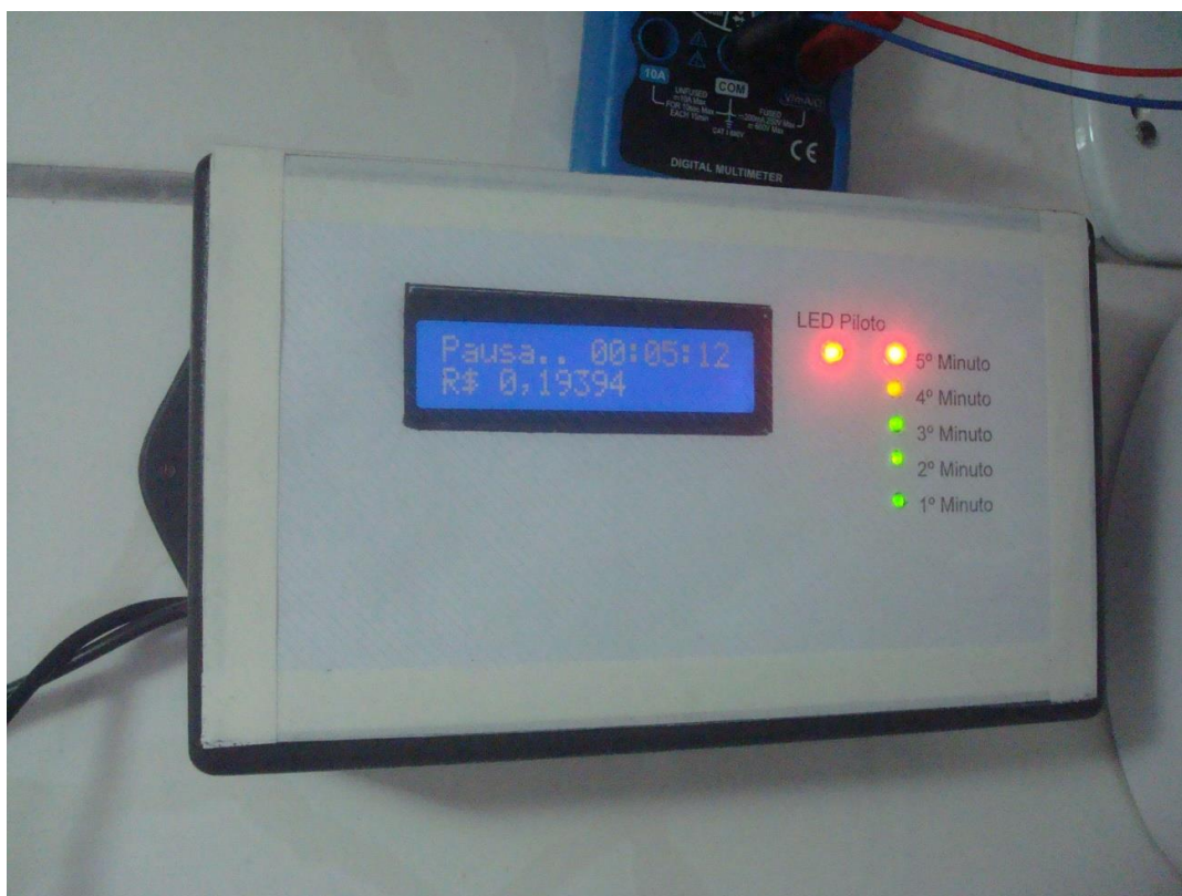
Figura 58: Equipamento em pausa mostrando o valor do banho em R$ após 5 minutos. Fonte: Autoria própria.
