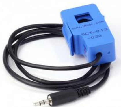
Figura 18: Encapsulamento do sensor de efeito Hall SCT013-100A. Fonte: Manual técnico do sensor de efeito Hall SCT013-100A (2014).
