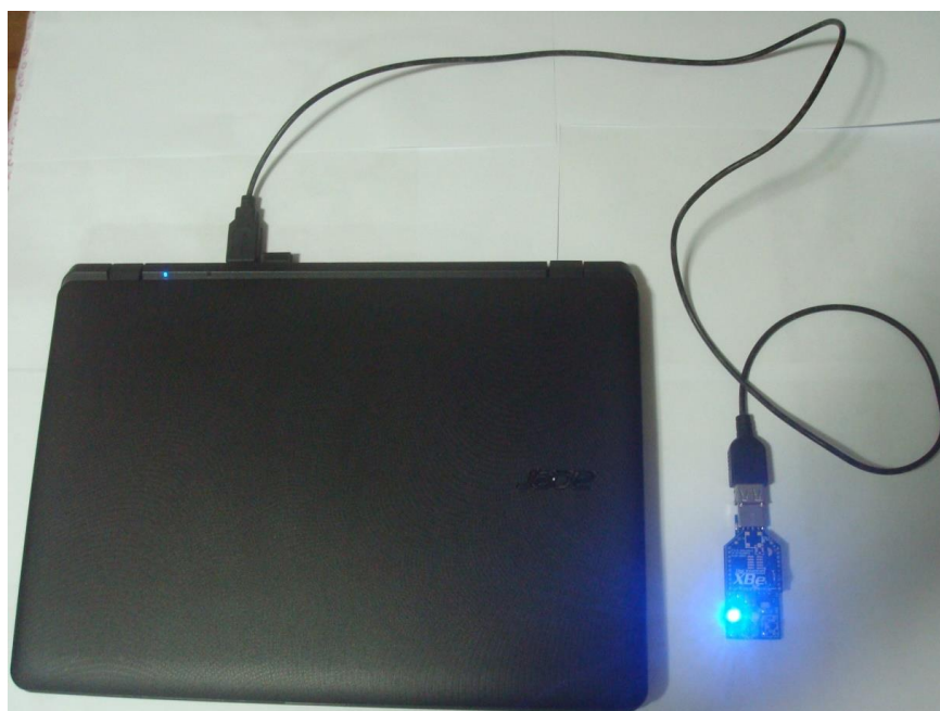
Figura 48: Módulo coordenador do ZigBee conectado ao PC. Fonte: Autoria própria.
