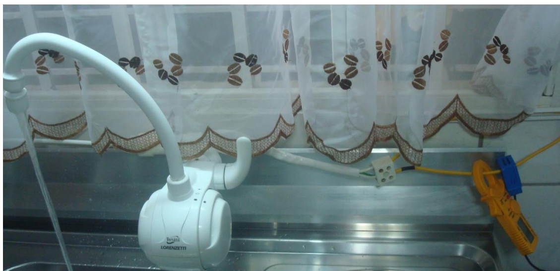
Figura 50: Conexão do equipamento com a torneira elétrica. Fonte: Autoria própria.
