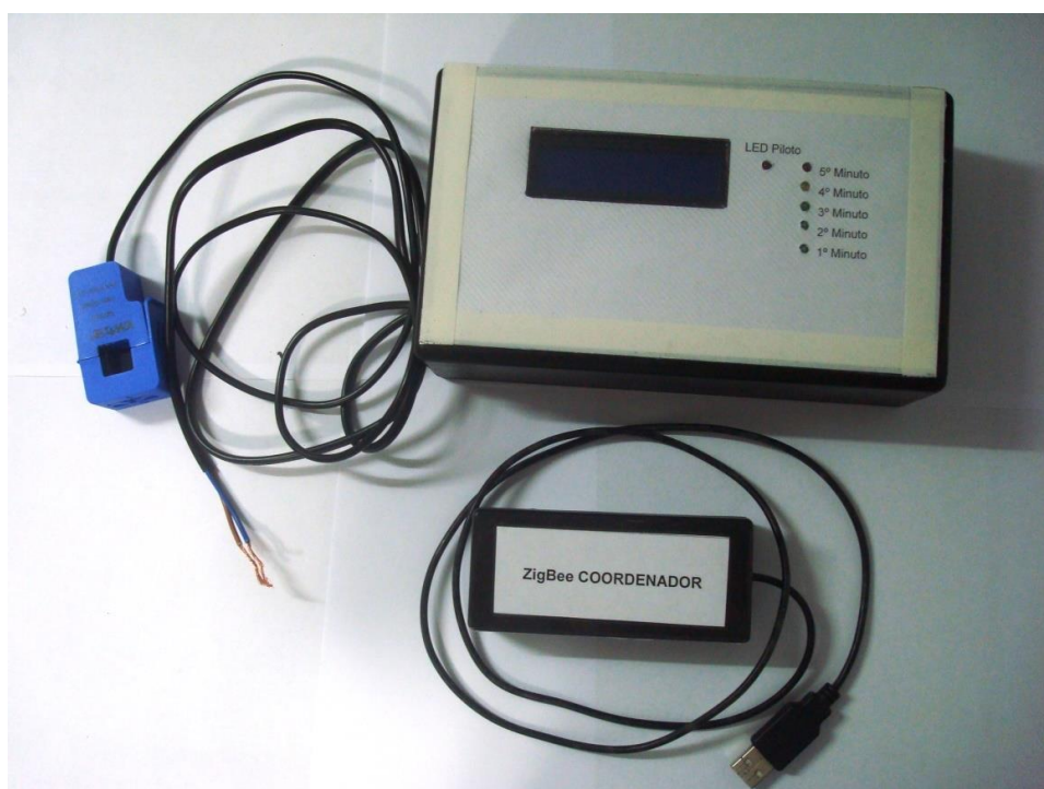
Figura 54: Equipamento final lacrado com o display e os LEDs de indicação. Fonte: Aatoria própria.
