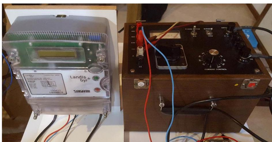
Figura 32 - Medidor Eletrônico e Carga Resistiva Variável.
