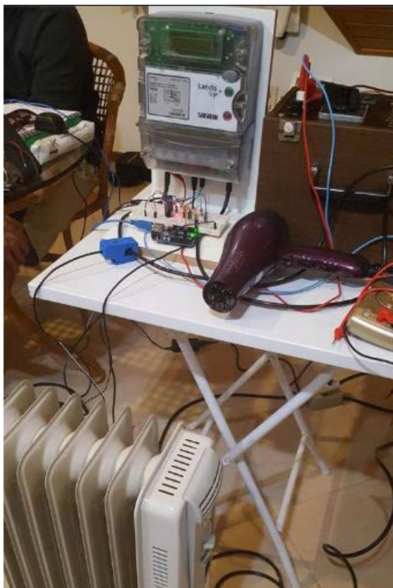
Figura 33 - Medição Realizada no Aquecedor e Secador de Cabelo.
