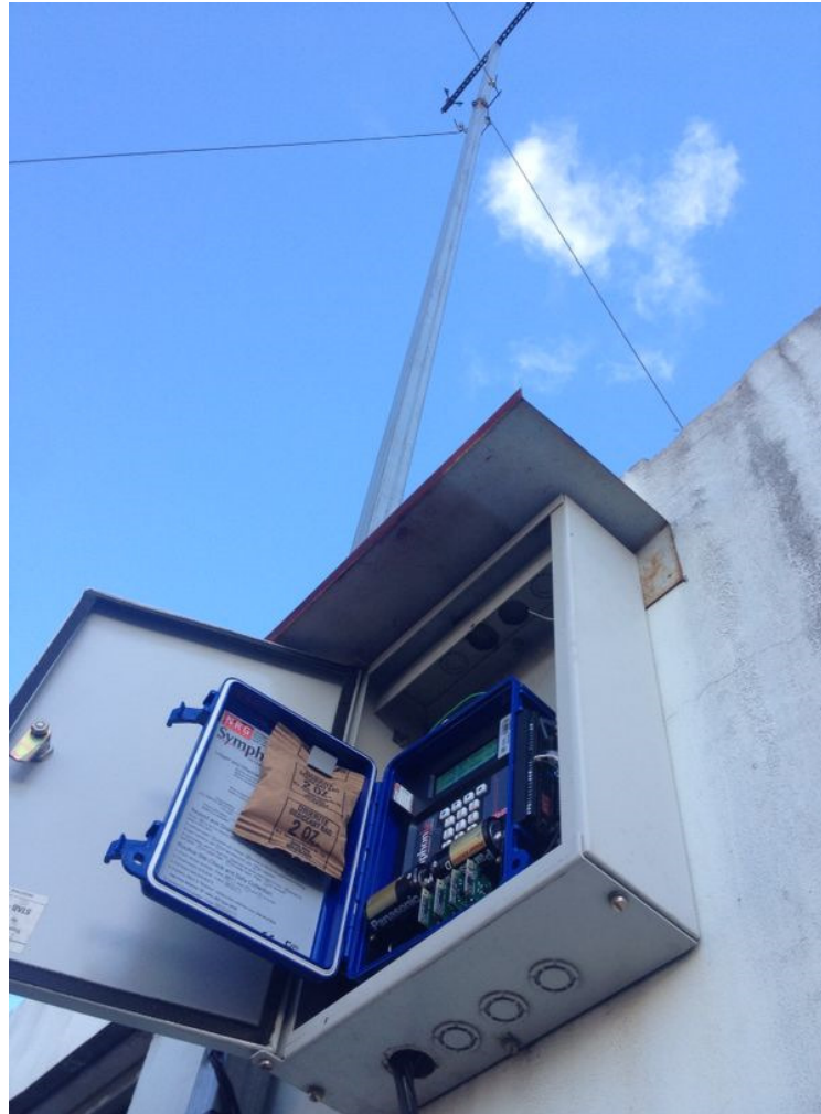
Figura 10: Disposição do Data logger dos sensores de medições instalados na UTFPR. Fonte: Autoria própria.
