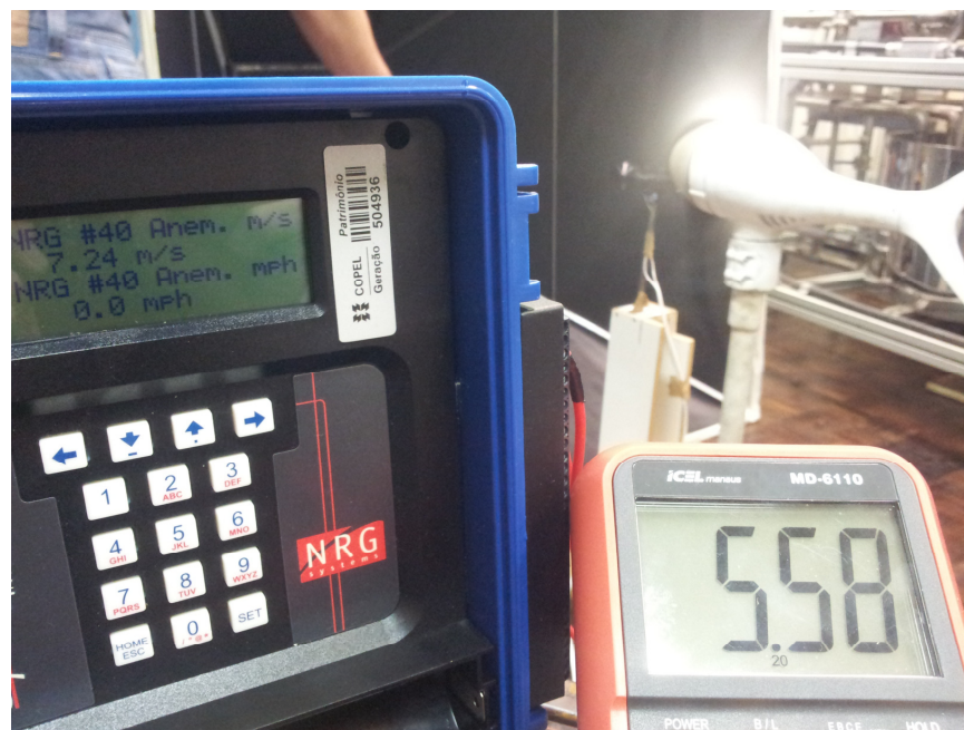
Figura 41: Tensão máxima gerada com o túnel de vento.
