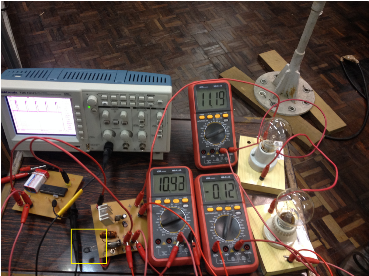
Figura 49: Conversor Boost (10W) em funcionamento com o gerador.
