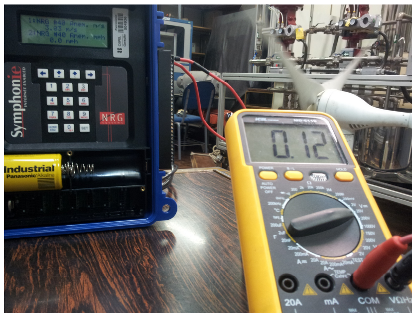
Figura 38: Partida do gerador em 3,03 m/s.
