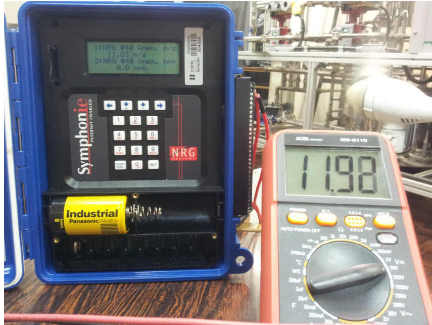
Figura 39: Gerador atinge sua tensão nominal em 11,83 m/s.
