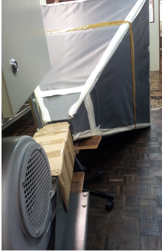
Figura 36: Túnel e gerador de vento.
