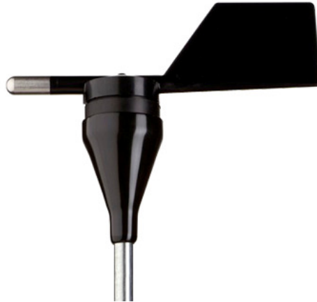
Figura 8: Sensor de direção do vento, modelo 200P da NRG Systems.
