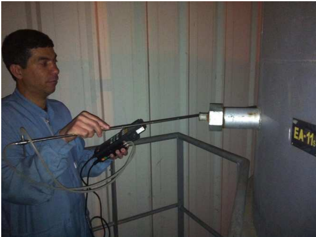
Figura 35: medição de vazão e pressão do vapor Fonte: autoria própria
