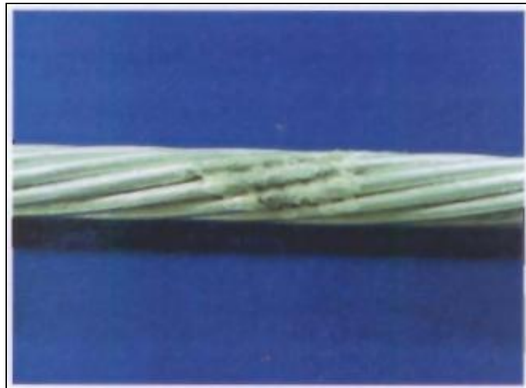
Figura 61 – Detalhe do cabo após o ensaio nº 13. Fonte: DLA-27161/2012.
