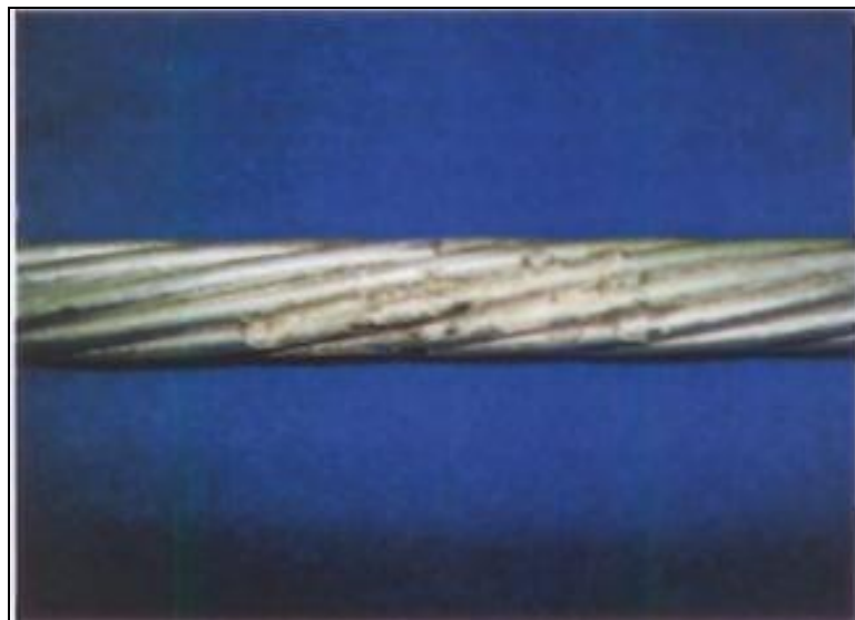
Figura 63 – Detalhe do cabo após o ensaio nº 15. Fonte: DLA-27161/2012.
