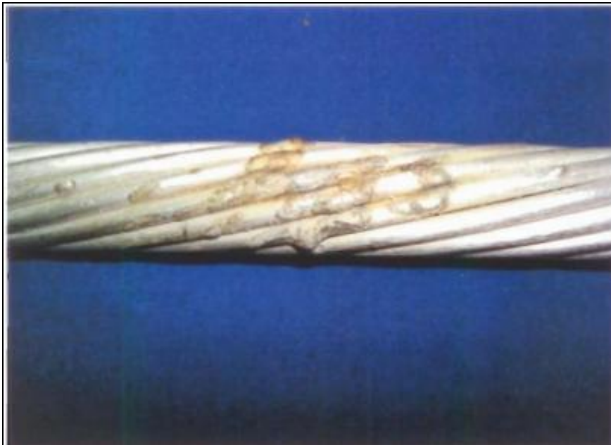
Figura 50 – Detalhe do cabo após o ensaio nº 1. Fonte: DLA-9876/2013.
