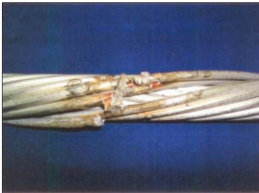
Figura 52 – Detalhe do cabo após o ensaio nº 3. Fonte: DLA-9876/2013.
