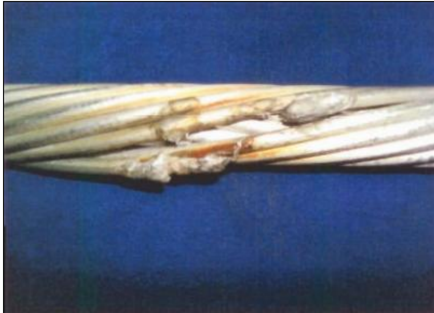
Figura 53 – Detalhe do cabo após o ensaio nº 4. Fonte: DLA-9876/2013.
