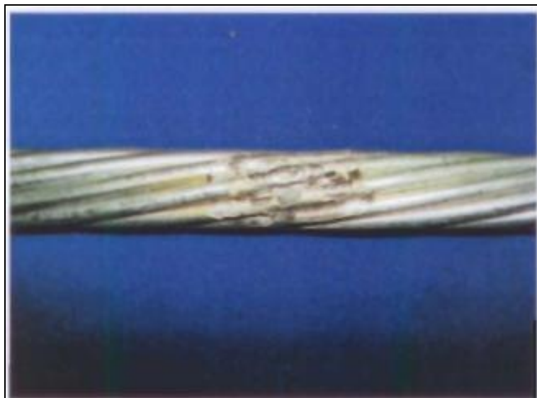
Figura 64 – Detalhe do cabo após o ensaio nº 16. Fonte: DLA-27161/2012.
