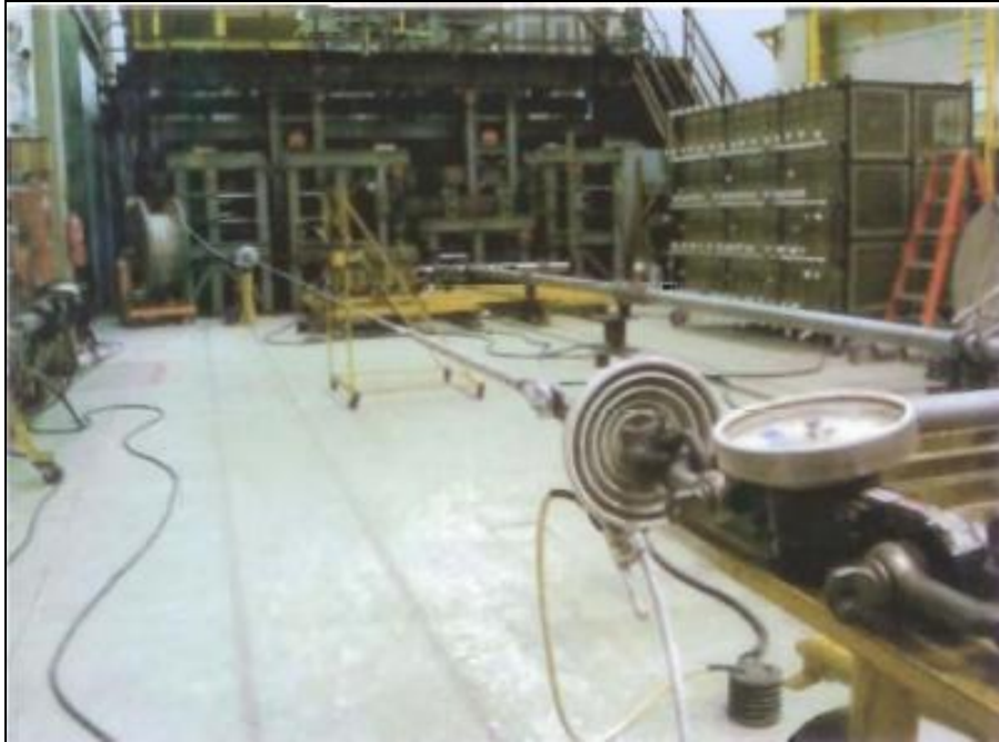
Figura 49 – Arranjo para o Ensaio de descarga atmosférica.. Fonte: DLA-9876/2013.
