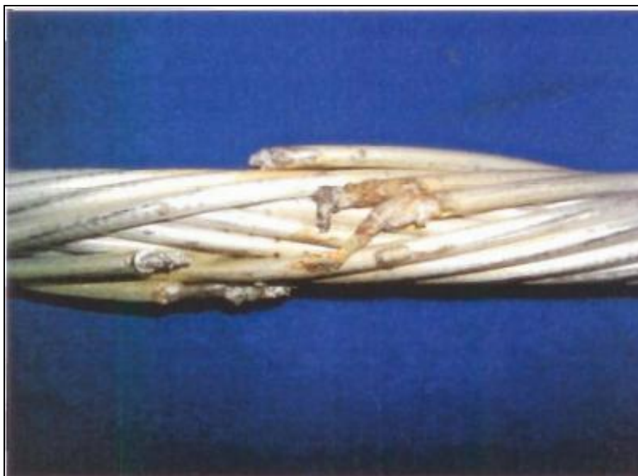
Figura 51 – Detalhe do cabo após o ensaio nº 2. Fonte: DLA-9876/2013.
