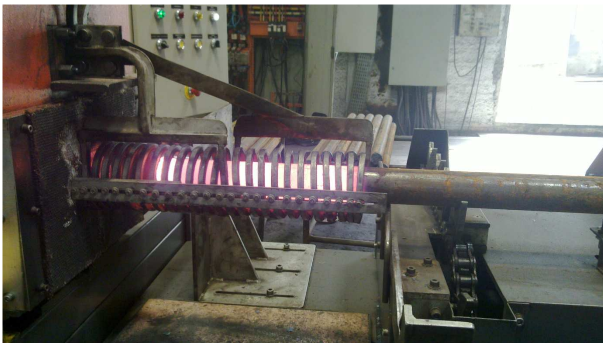
Figura 30 – Detalhe da Bobina de Aquecimento
