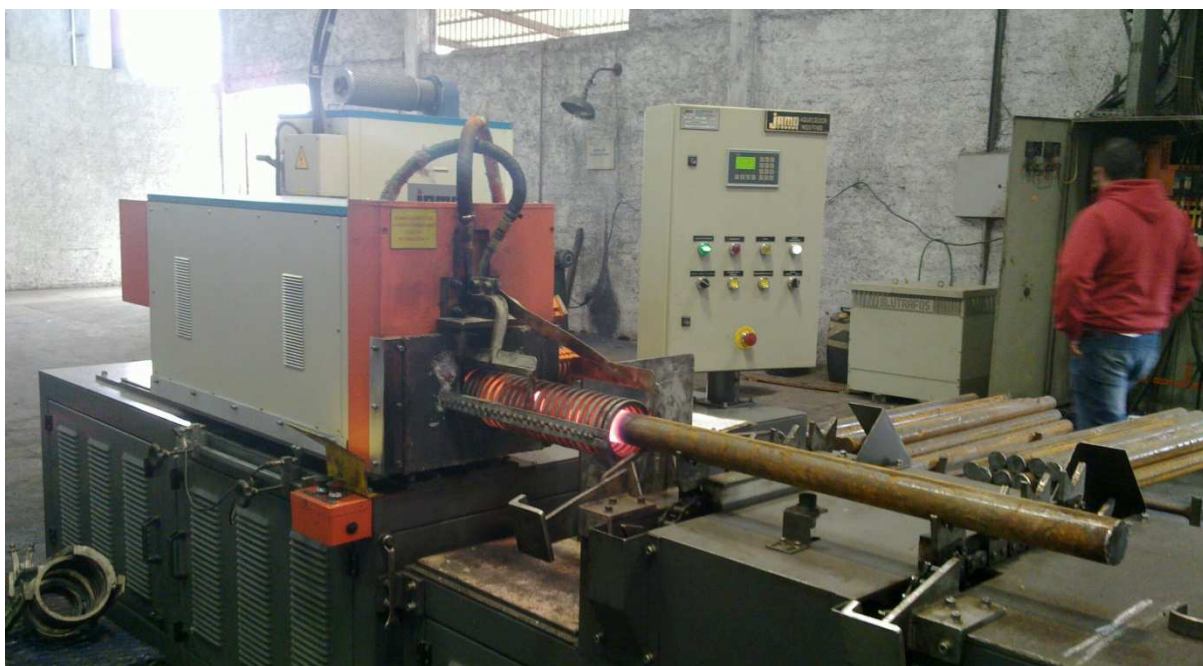
Figura 29 – Detalhe do Forno a Indução em Funcionamento
