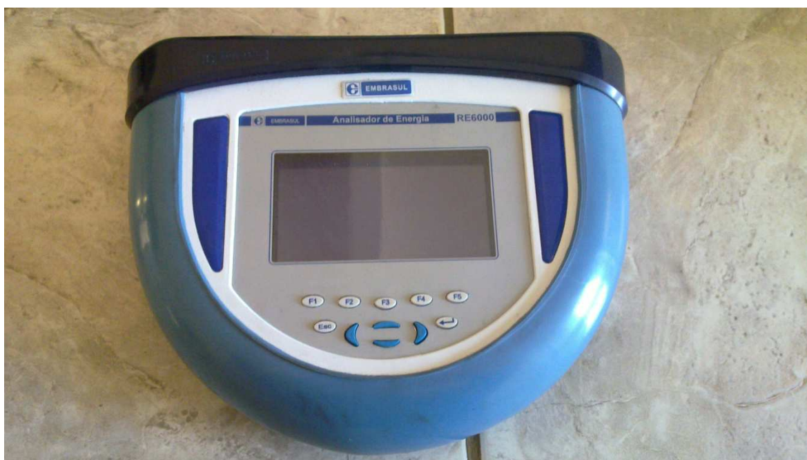
Figura 33 – Detalhe do Analisador de Energia
