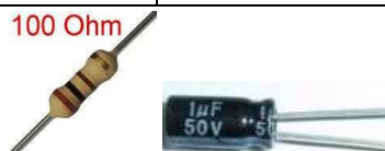
Figura 5 - Filtro RC (100Ω + 1 μF). Fonte: Autoria própria.
