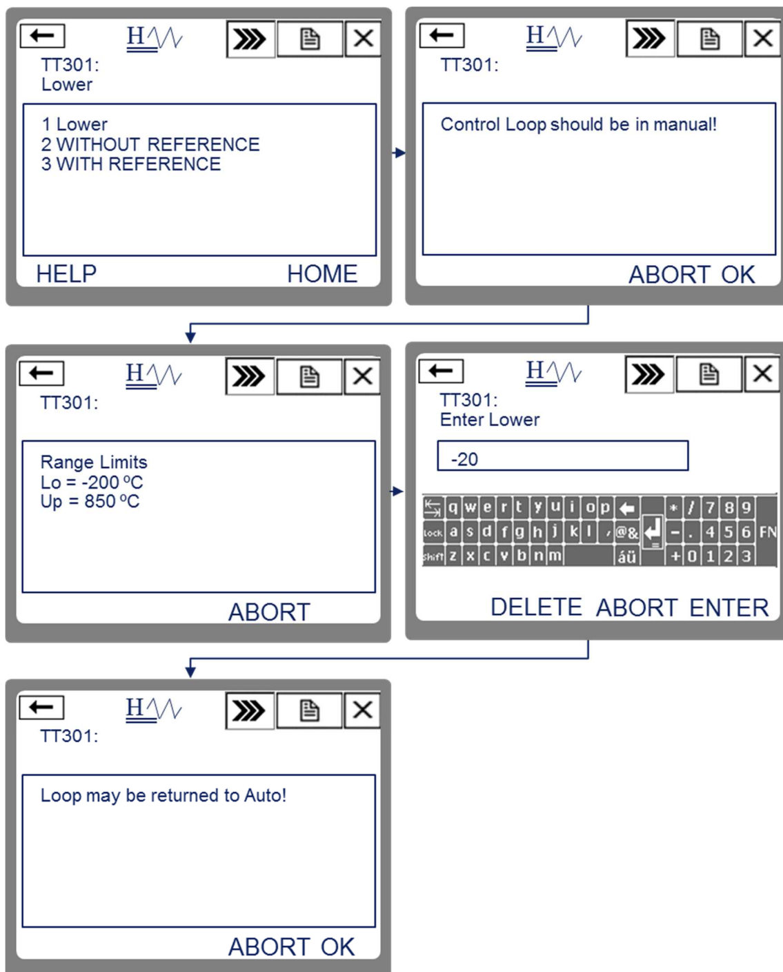
Figura 3.40 - Configuração da faixa de medição TT301 HART Fonte: Autoria própria
