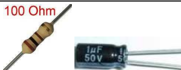
Figura 5 - Filtro RC ( 100\Omega + 1\mu\text{F} ). Fonte: Autoria própria
