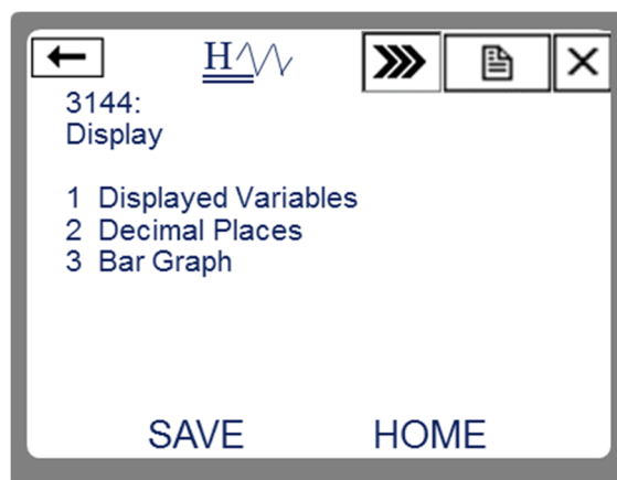
Figura 3.18 - Configuração do visor local do 3144 HART Fonte: Autoria própria
