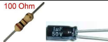
Figura 5 - Filtro RC ( 100\Omega + 1\mu F ). Fonte: Autoria própria
