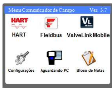
Figura 6 – Área de trabalho do 475. Fonte: Autoria própria.
