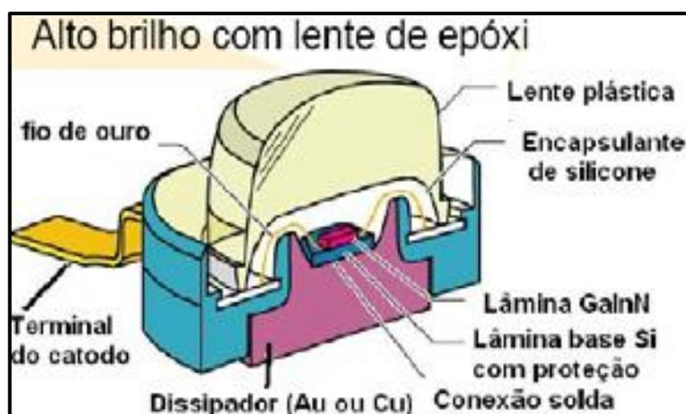
Figura 15 – Estrutura de um HB-LED
