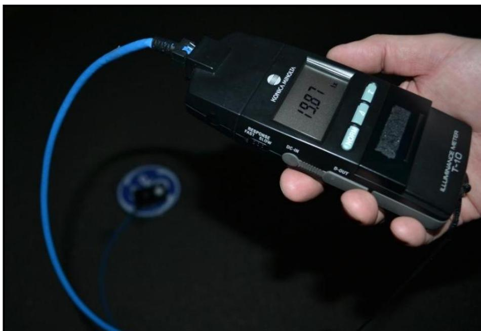
Figura 28 – Luxímetro utilizado nas medições
