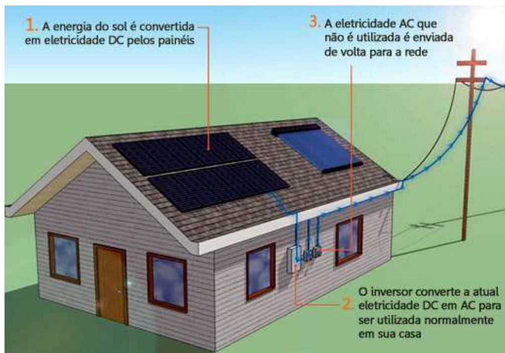
Figura 18 – Geração distribuída a partir de um SFCR.
