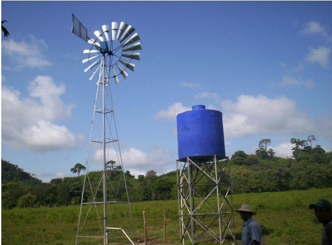
Figura 2.1 - Moinho de vento tipo leque sendo utilizado para bombear água.
