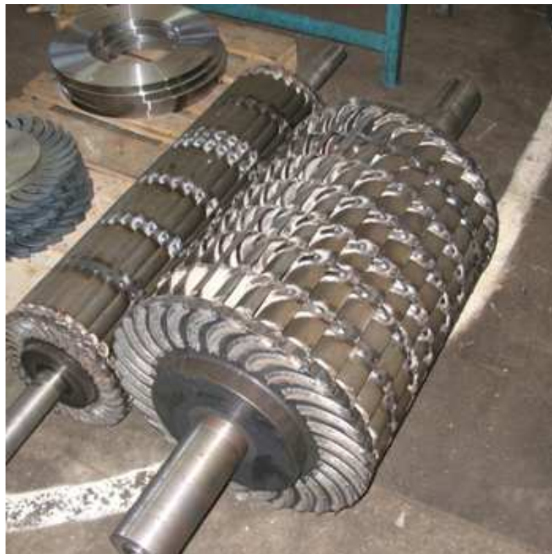
Figura 16: Rotor Banki. Fonte: Accessecosolar, 2012.
