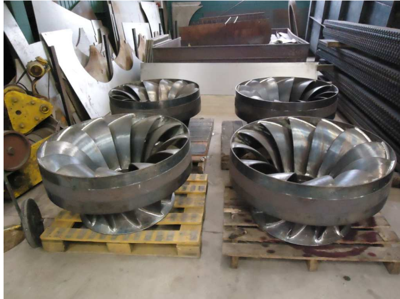
Figura 11: Rotor de turbina Francis dupla eixo horizontal. Fonte: Própria, 2012.
