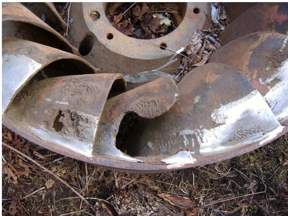
Figura 26 – Danos causados por cavitação em uma Turbina Francis. Fonte: Wikipédia, 2012.
