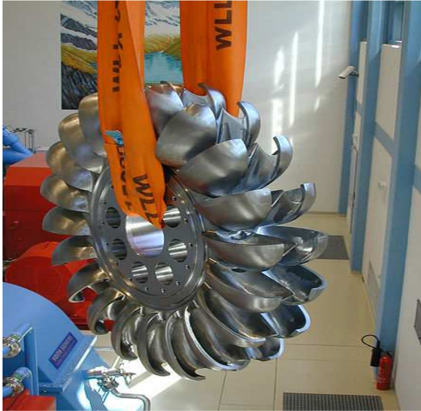
Figura 9: Rotor Pelton Fonte: Vivendo Eletricidade, 2012.
