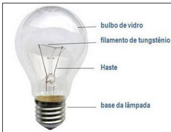
Figura 10 - Composição de lâmpadas incandescentes Fonte: Philips [entre 2004 e 2012].
