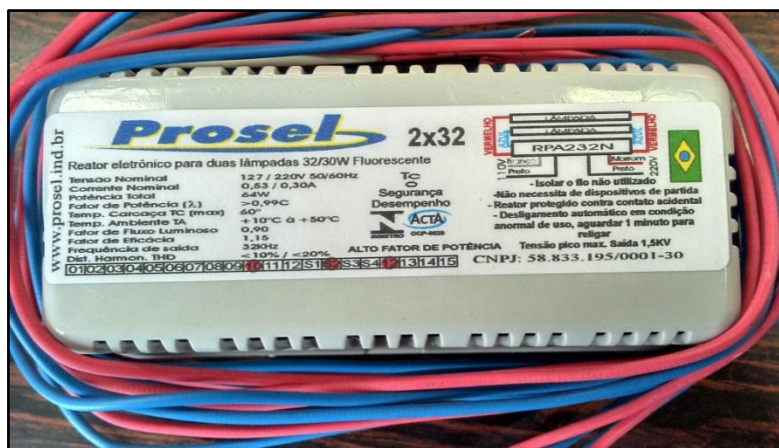
Figura 54 - Reator atualmente utilizado nas lâmpadas de 32 W Fonte: Autores.
