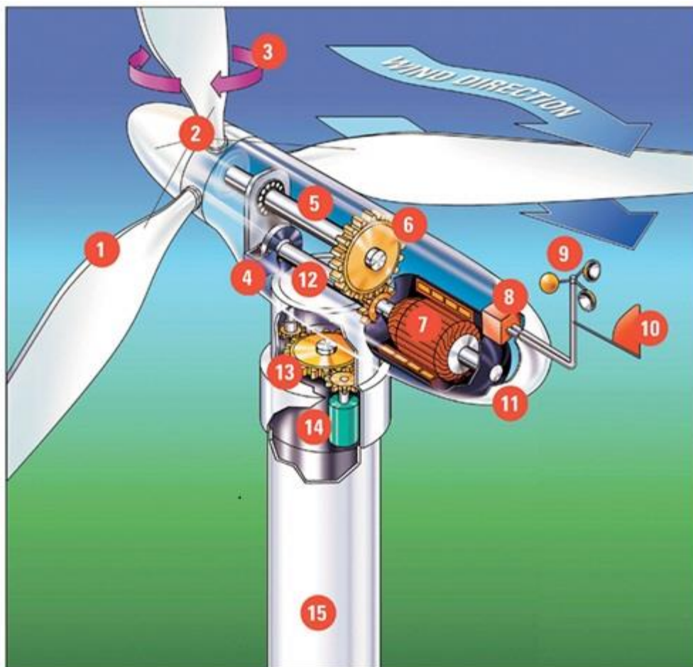
Figura 53 - Vista do interior da nacela de uma turbina eólica
