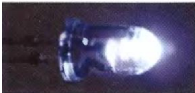
Figura 78 - Emissão de luz branca a partir de uma LED azul III-nitreto contendo fósforo
