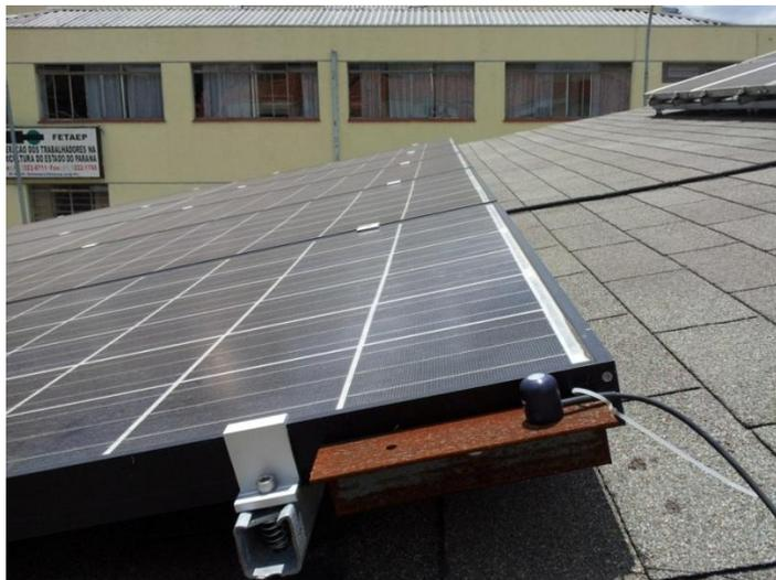
**Figura 34 – Piranômetro instalado junto ao painel fotovoltaico do EV.**
