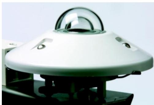
**Figura 6 – Piranômetro termoeletrico de primeira classe.**
