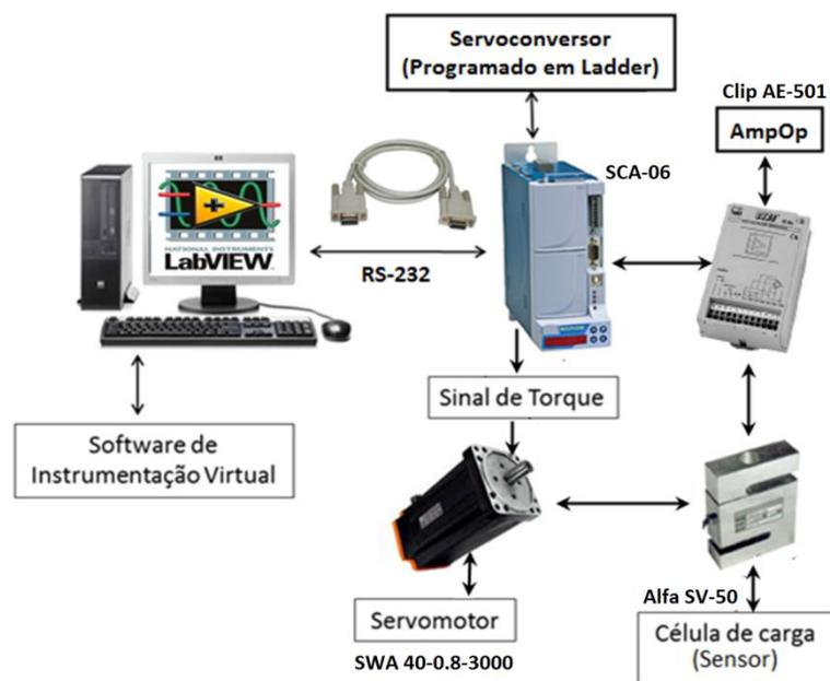
**Figura 2 - Esquema dos materiais e equipamentos utilizados**
