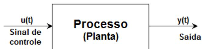
Figura 3 - Representação de um sistema de controle em malha aberta
