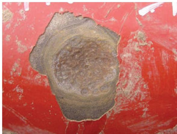
**Figura 3 - Corrosão em duto devido corrente alternada de linha de transmissão próxima.
