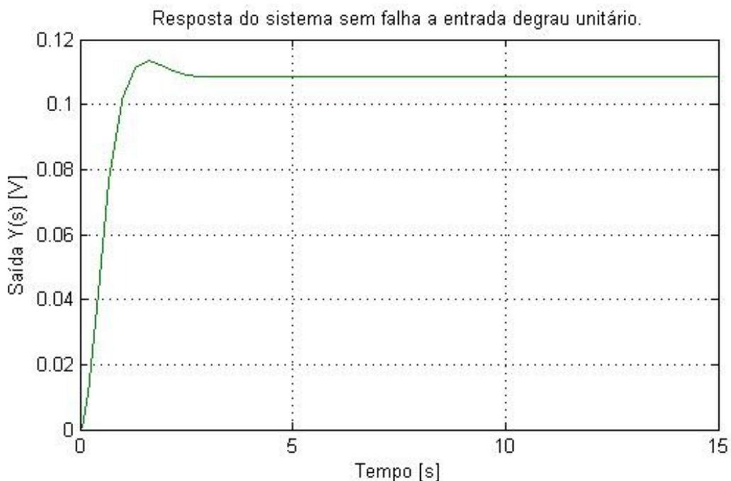
**Figura 3 - Resposta para degrau unitário - Controlador Cardíaco sem falha.**
