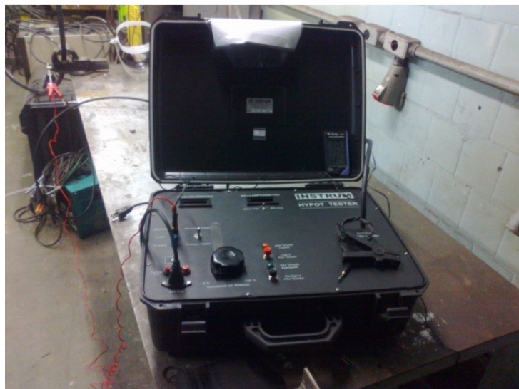
Figura 53 – Equipamento Hipot instalado em bancada de serviço, antes da realização dos ensaios.
