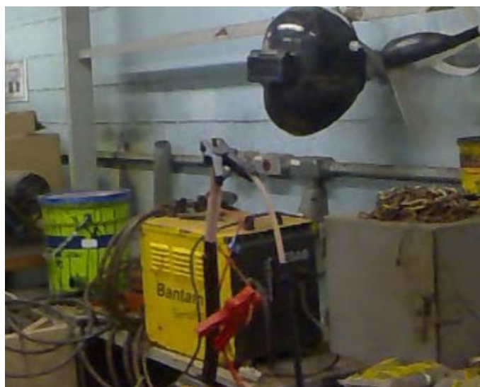
Figura 58 – Terminais ligados ao cabo.
