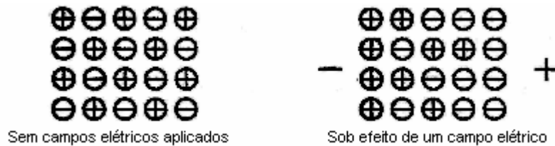
Figura 17 – Polarização por cargas especiais a partir de um Campo Elétrico aplicado
