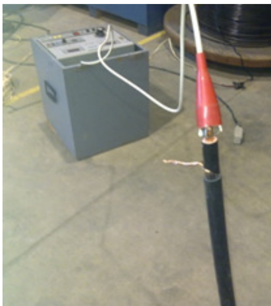
Figura 62 - Extremidade conectada ao equipamento.
