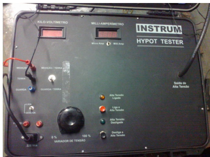
Figura 54 – Vista do painel de controle do equipamento Hipot, com as respectivas conexões realizadas.
