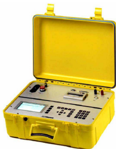
Figura 28 - Equipamento RVM Medidor automático de tensão de retorno
