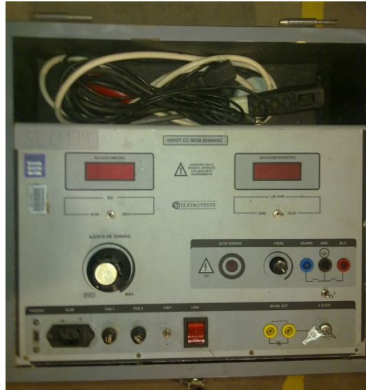
Figura 60 – Equipamento Hipot utilizado para a realização do ensaio 02.
