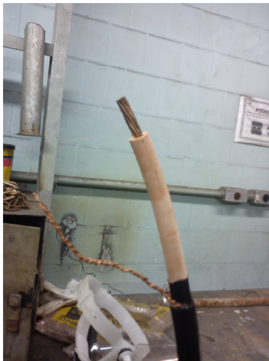
Figura 57 - Extremidade preparada para receber os terminais do equipamento de teste.
