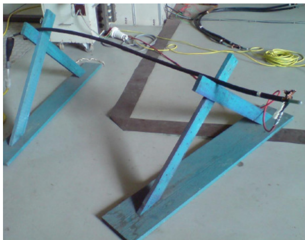
Figura 38 –Amostra de cabo preparada para medições, após o ensaio.
