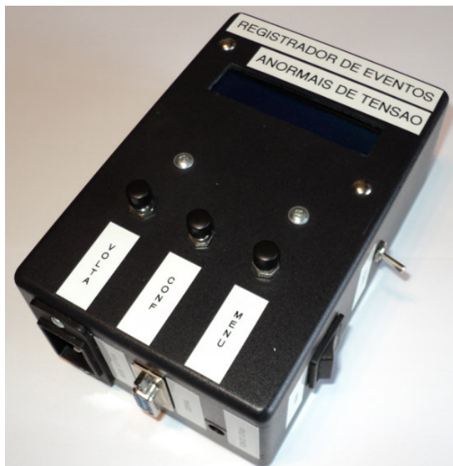
Figura 17 – Montagem final do protótipo
