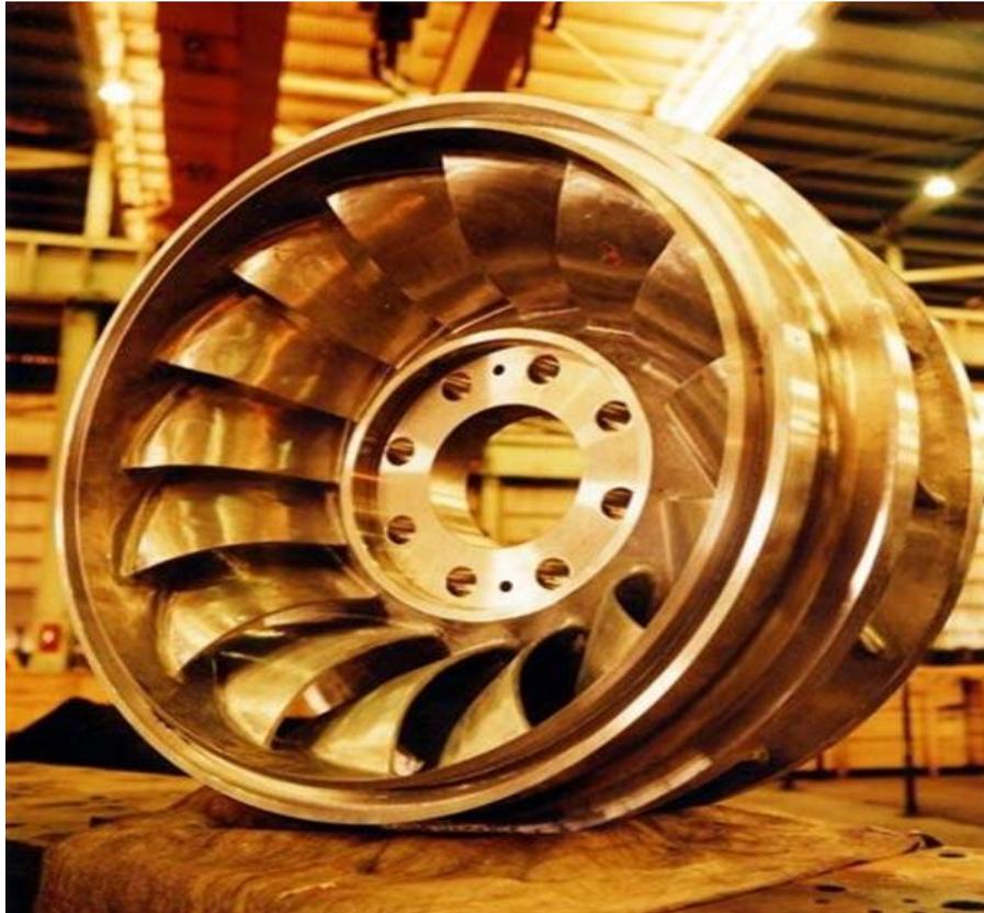
Figura 17 – Rotor da Turbina Francis
