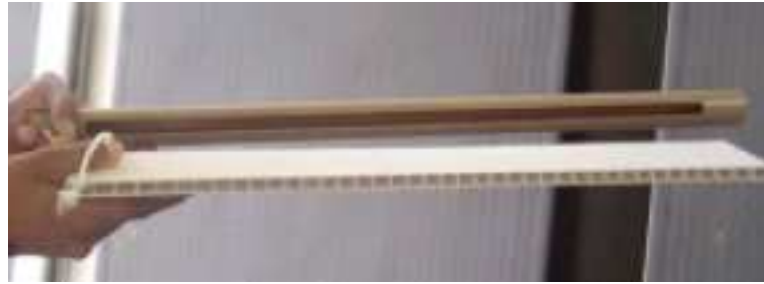
Figura 20 - Placa de forro de PVC usada para construção dos coletores Fonte: SOCIEDADE DO SOL, 2009
