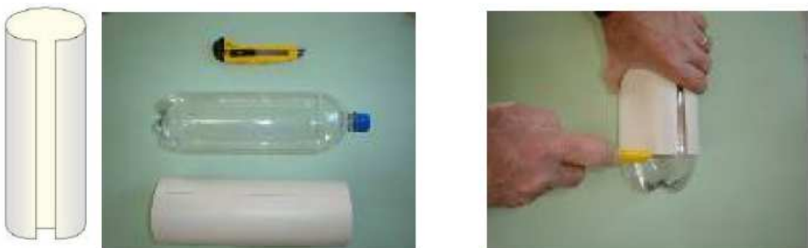
Figura 29 - Método de corte das garrafas PET Fonte: ALANO, 2004
