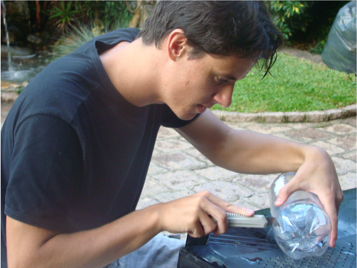
Figura 42 - Garrafa PET em processo de corte com estilete Fonte: ARQUIVO PESSOAL, 2011
