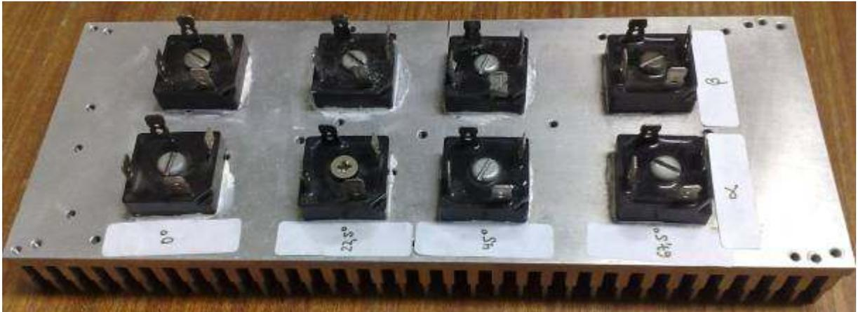
Figura 67 - Arranjo das pontes retificadoras sobre o dissipador.
