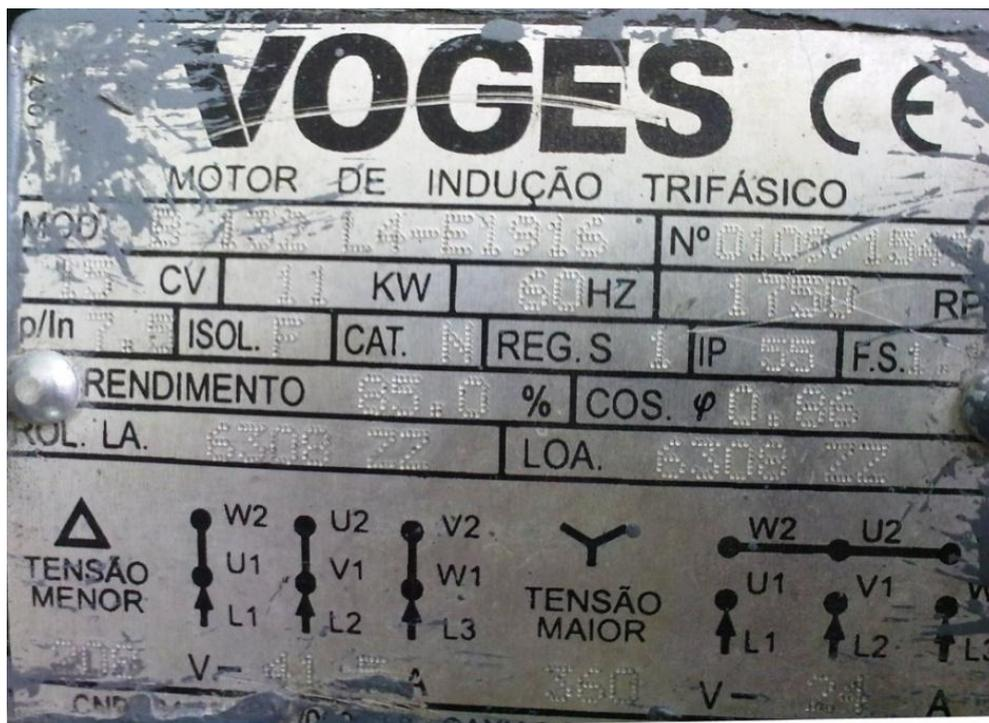
Figura 30 - Placa de Identificação do motor do elevador
