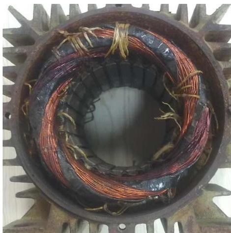
**Figura 12 - Estator bobinado.**
