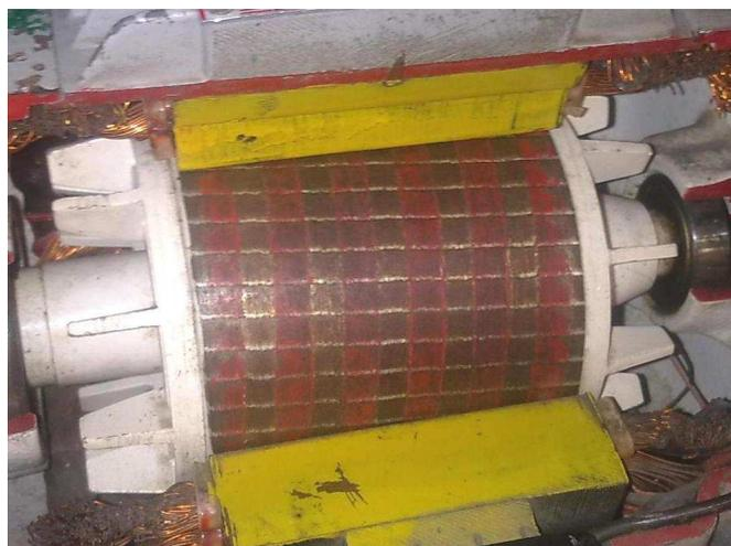
**Figura 14 - Rotor tipo gaiola de esquilo.**
