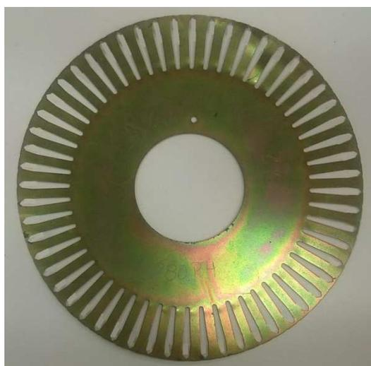
**Figura 13 - Chapa do rotor tipo gaiola de esquilo.**
