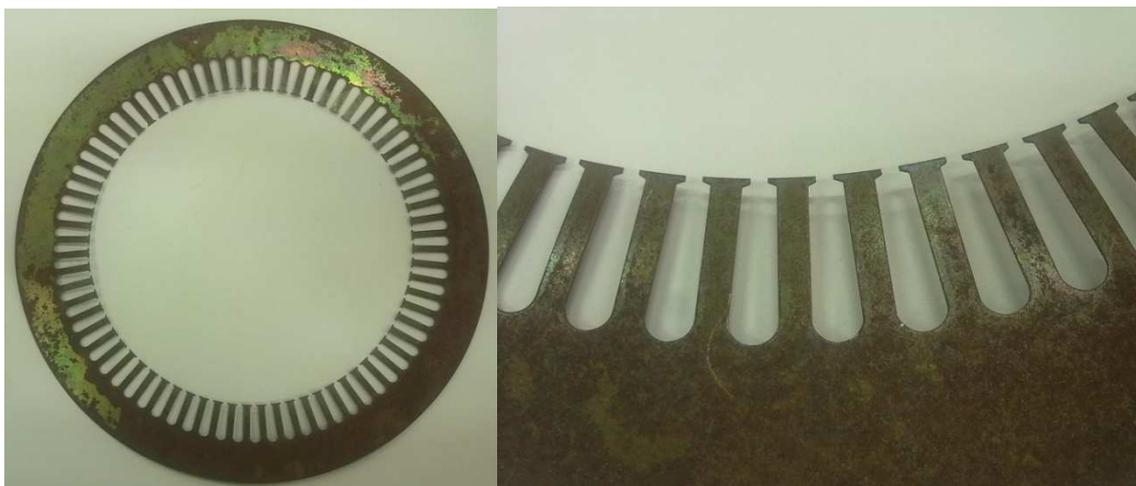
**Figura 11 - Chapa do estator e detalhe.**
