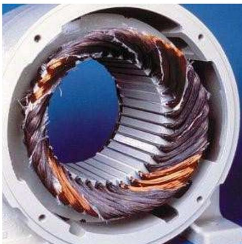
**Figura 28 - Motor com falta de fase ligado em estrela**
