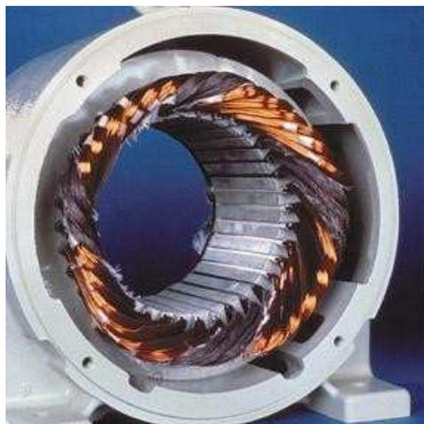
**Figura 29 - Motor com falta de fase ligado em triângulo**
