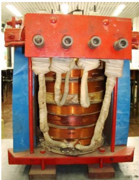
**Figura 8 - Transformador monofásico rural.**
