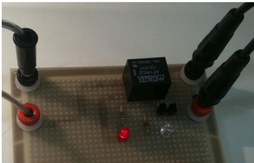
**Figura 31 – Circuito de acionamento da válvula**
