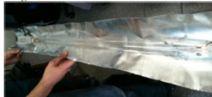
**2ª Etapa: Introdução da calha no interior do tubo de PVC:** Inserir a calha, juntamente com a lâmpada e o reator, no tubo de PVC conforme figura abaixo.
