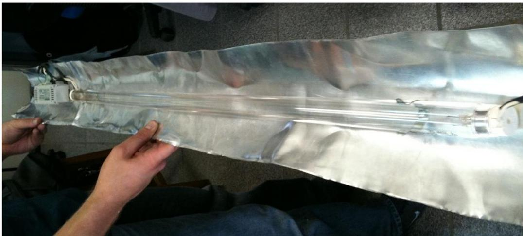
**Figura 23 – Calha de alumínio com reator e lâmpada**
