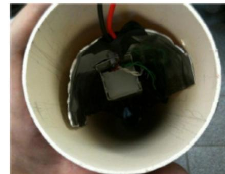
**3ª Etapa: Entrada de água:** Por questões de segurança, o sistema de desinfecção deve ser abrigado. A exposição frequente à radiação ultravioleta pode causar danos à pele e aos olhos. Para isso são utilizados caps. Marcar o cap com uma caneta utilizando a flange como molde. Fazer a perfuração do cap com uma serra copo, permitindo o encaixe da flange. Para a passagem dos fios de alimentação do reator, fazer um furo adicional no cap como mostrado abaixo.
