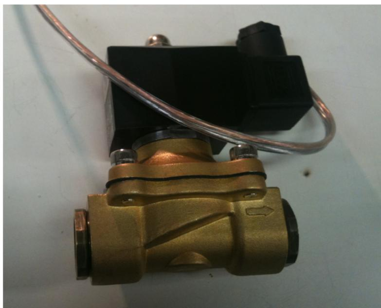
**Figura 32 – Válvula solenóide**
