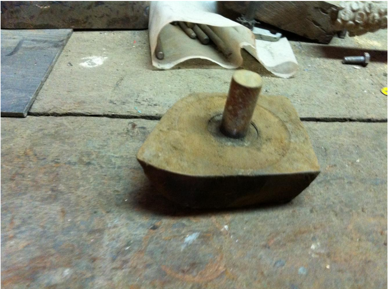
Figura 73 – Peça utilizada para fazer a punção no processo de estampagem para fabricação das pás de uma turbina Francis fabricada artesanalmente.
