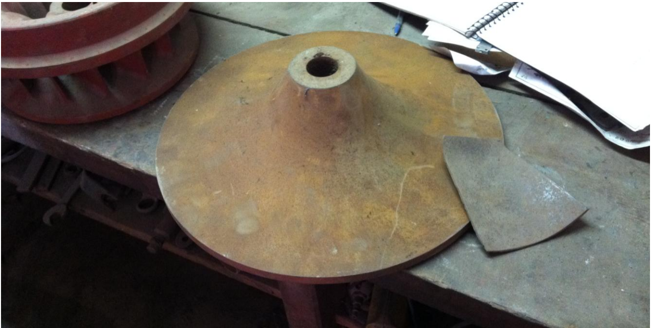
Figura 78 - Base onde serão montadas as pás de uma turbina Francis fabricada artesanalmente. Fonte: do autor.
