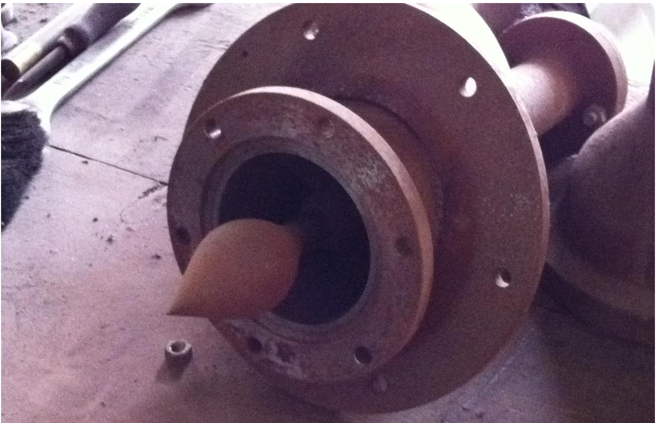
Figura 68 – Conjunto do injetor de uma turbina Pelton fabricada artesanalmente. Fonte: do autor.
