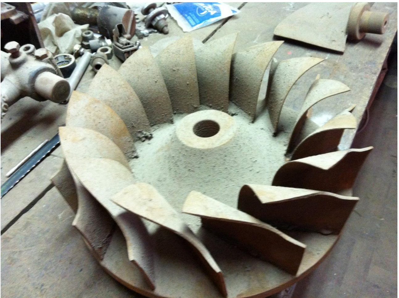
Figura 79 - Pás montadas sobre base no processo de montagem de uma turbina Francis fabricada artesanalmente. Fonte: do autor.
