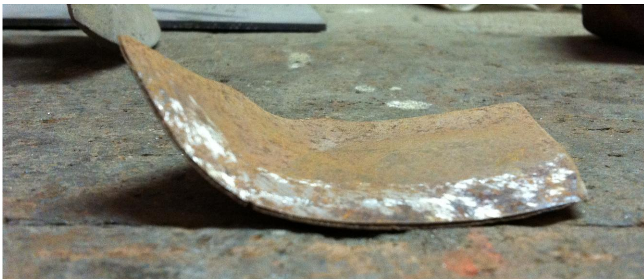
Figura 76 – Pá produzida a partir do processo de estampagem para fabricação das pás de uma turbina Francis fabricada artesanalmente. Fonte: do autor.
