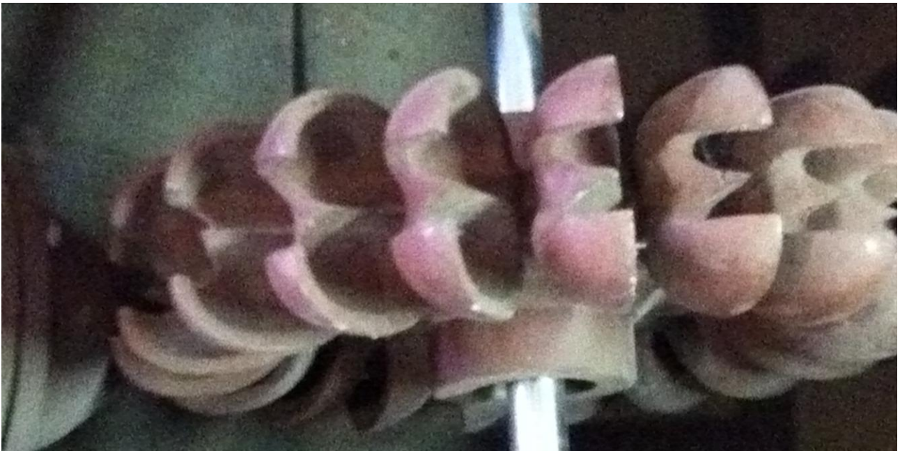
Figura 70 – Rotor de uma turbina Pelton fabricada artesanalmente. Fonte: do autor.
