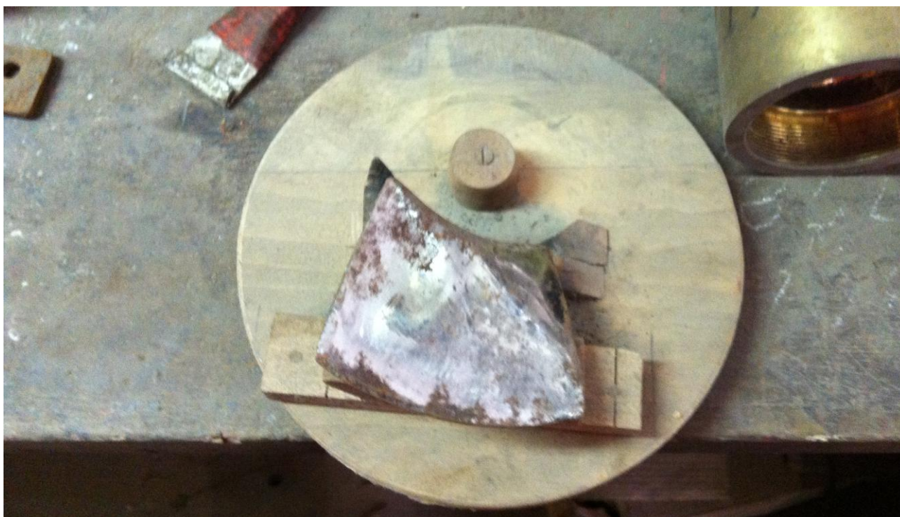
Figura 83 – Pá e gabarito de madeira utilizado no processo de montagem de uma turbina Hélice fabricada artesanalmente.
