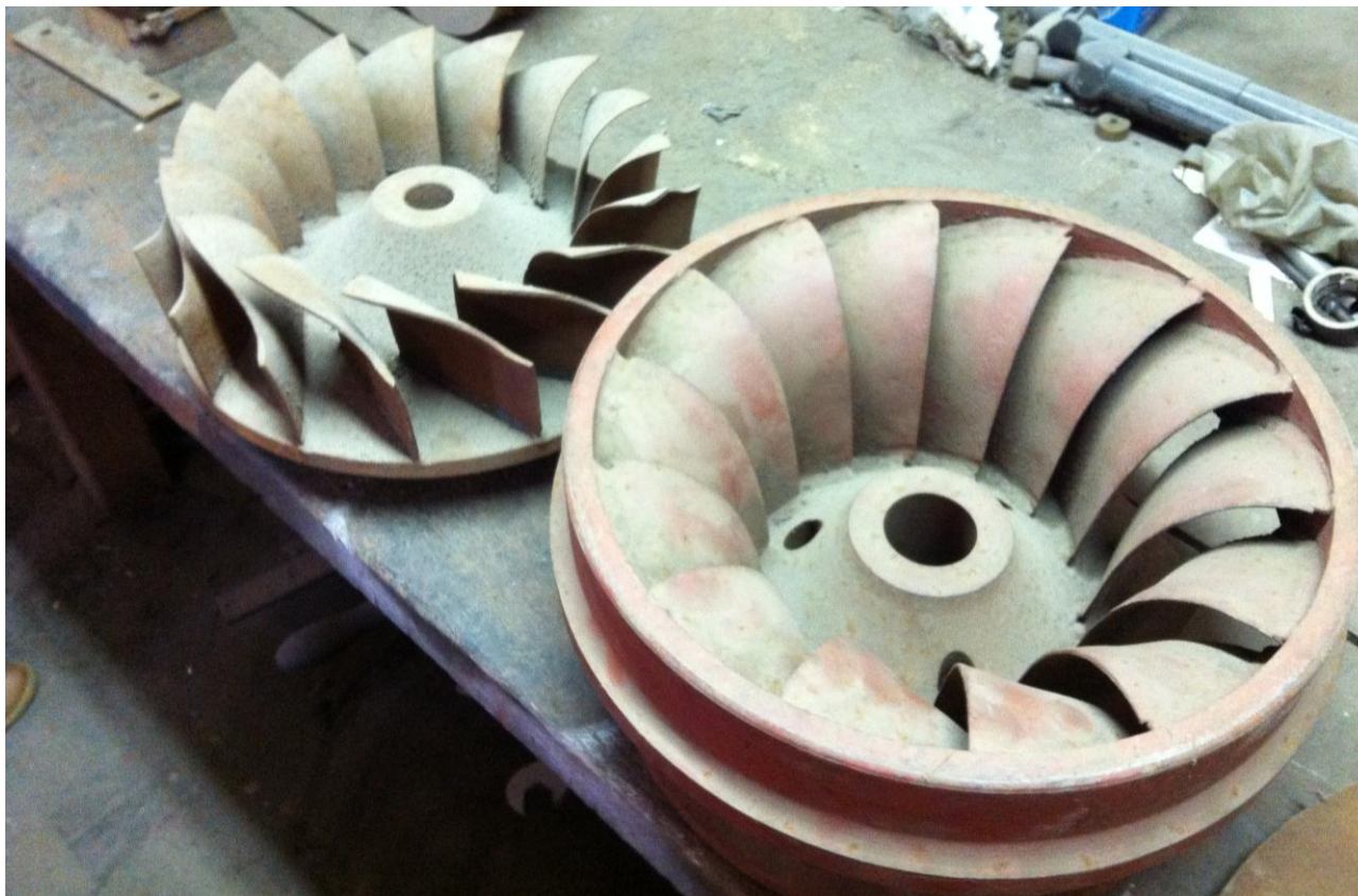
Figura 80 – Conjunto do processo de montagem de uma turbina Francis fabricada artesanalmente. Fonte: do autor.
