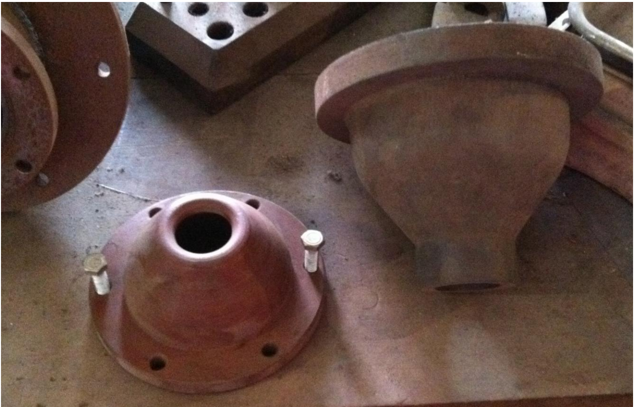
Figura 66 – Molde em madeira do bocal do injetor de uma turbina Pelton artesanal. Fonte: do autor.
