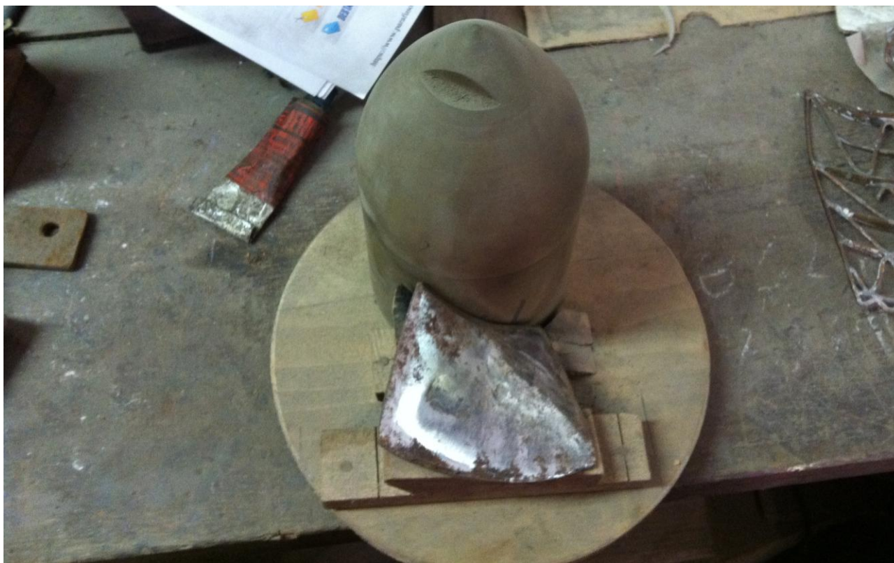
Figura 84 – Rotor, pá e gabarito de madeira utilizado no processo de montagem de uma turbina Hélice fabricada artesanalmente. Fonte: do autor.
