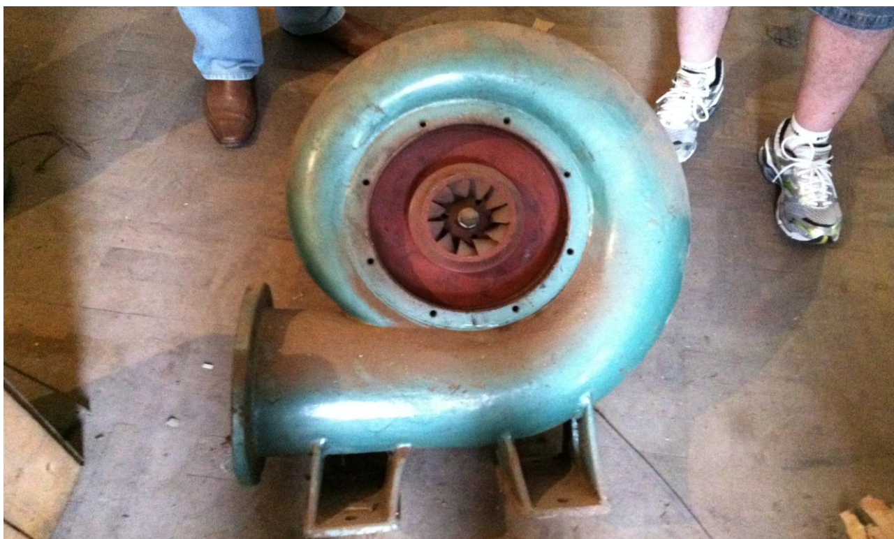
Figura 81 – Turbina Francis fabricada artesanalmente. Fonte: do autor.
