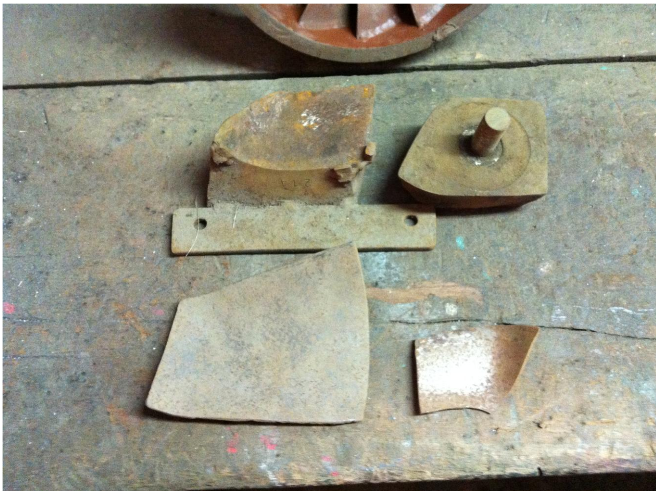
Figura 77 – Conjunto do processo de estampagem para fabricação das pás de uma turbina Francis fabricada artesanalmente. Fonte: do autor.
