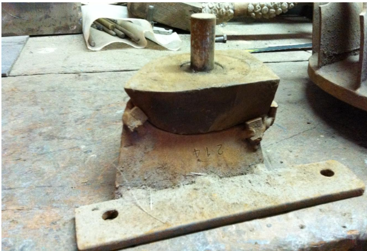
Figura 75 – Conjunto da matriz e peça utilizada para punção no processo de estampagem para fabricação das pás de uma turbina Francis fabricada artesanalmente. Fonte: do autor.
