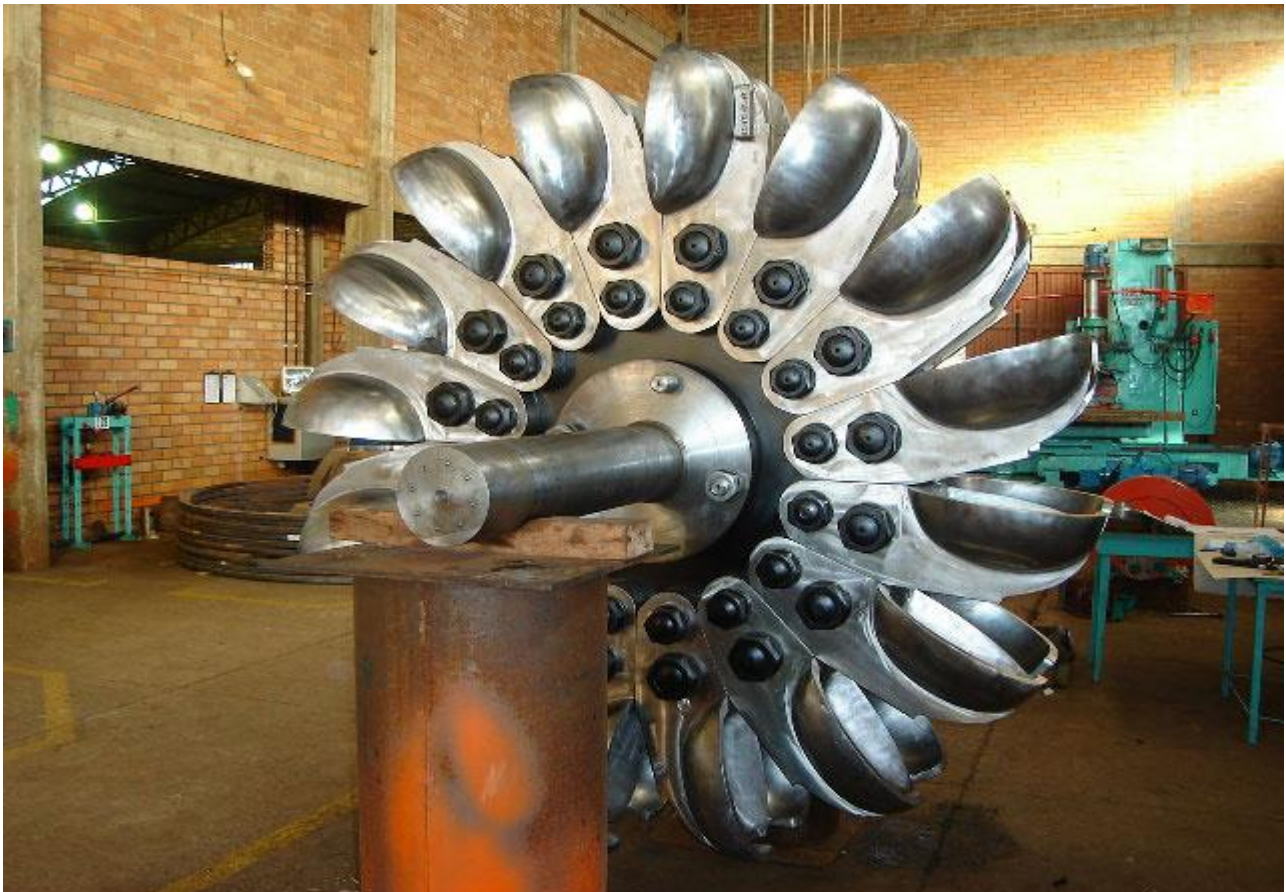
Figura 3 - Turbina Pelton - UHE Chaminé Fonte: Hacker, 2011.
