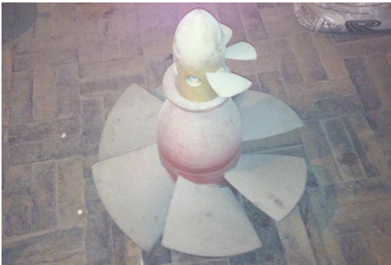
Figura 85 – Rotores de turbinas Hélices fabricadas artesanalmente. Fonte: do autor.
