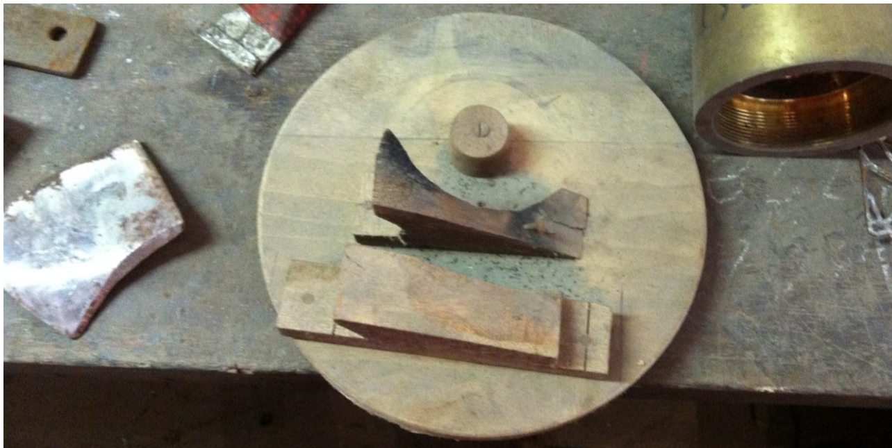
Figura 82 – Gabarito de madeira utilizado no processo de montagem de uma turbina Hélice fabricada artesanalmente.
