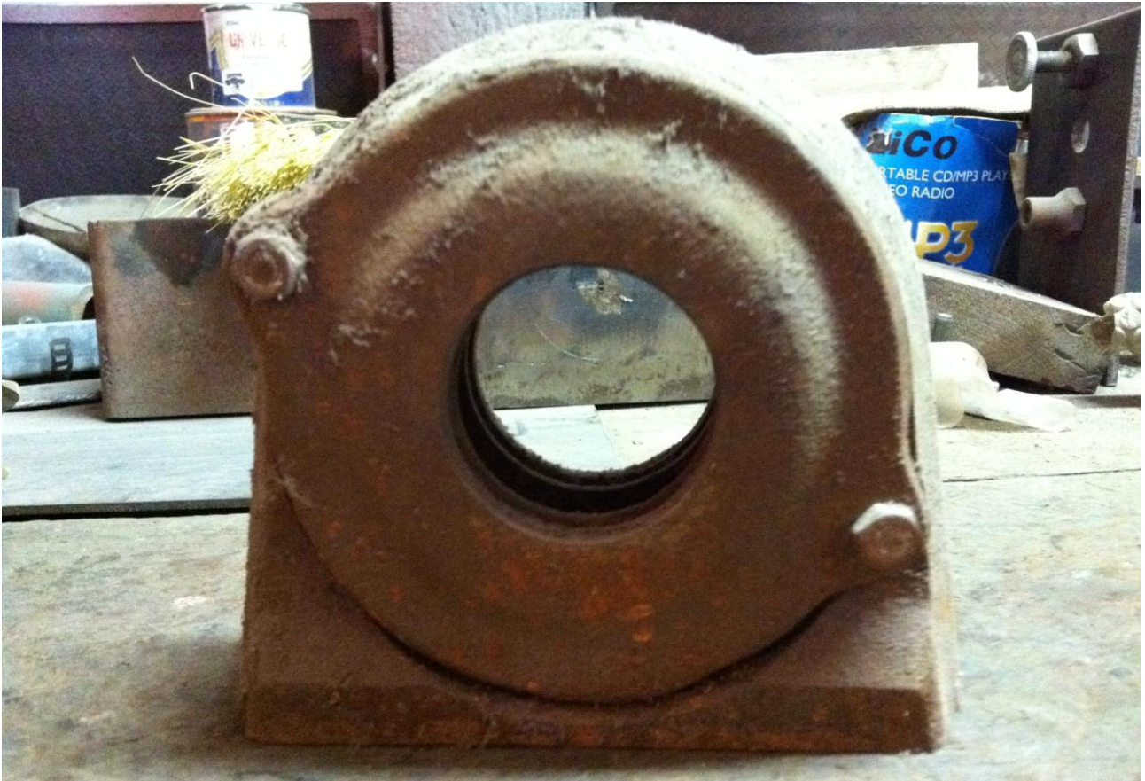
Figura 69 – Mancal de uma turbina Pelton fabricada artesanalmente. Fonte: do autor.
