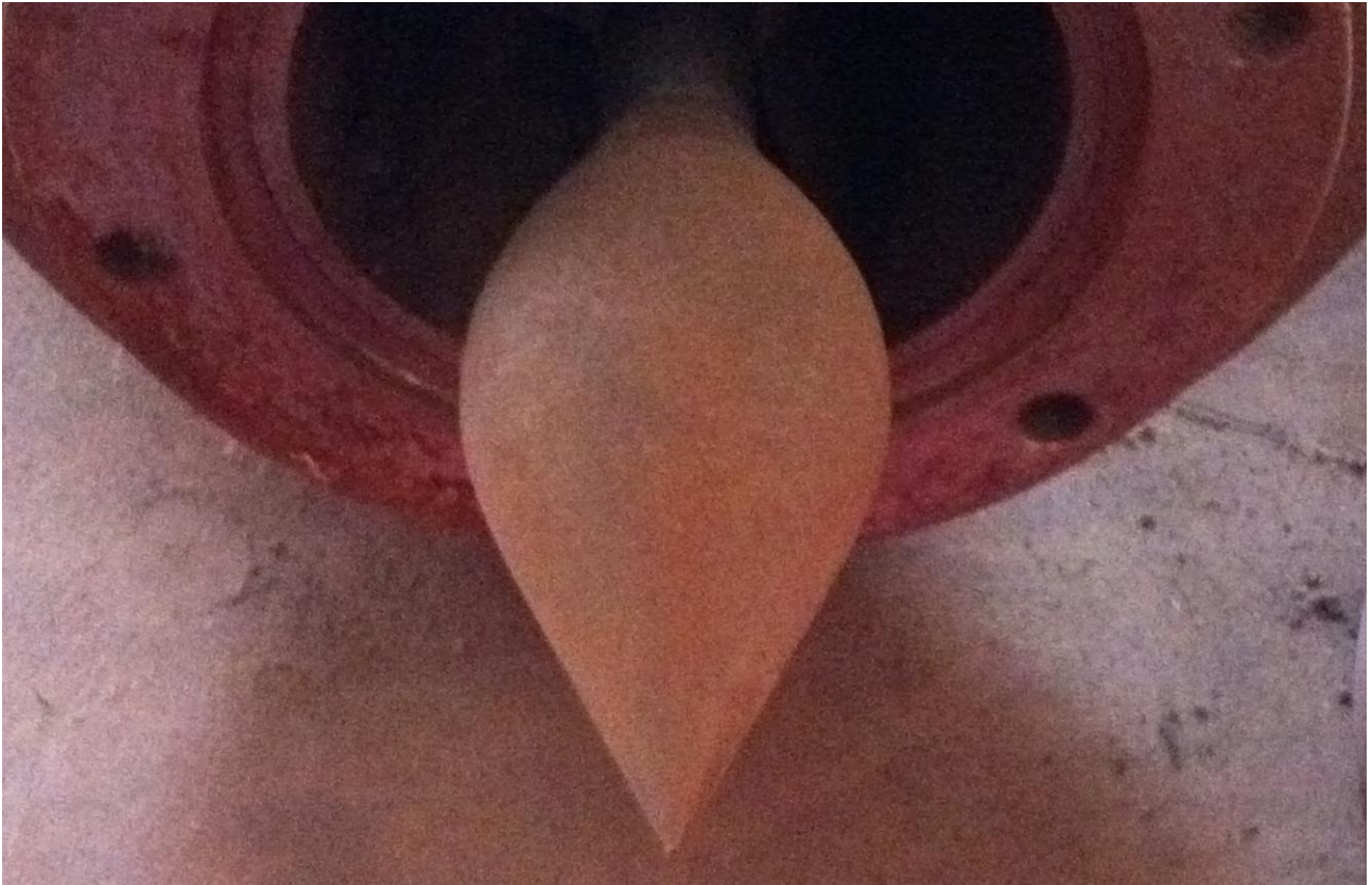
Figura 67 – Agulha do injetor de uma turbina Pelton fabricada artesanalmente. Fonte: do autor.
