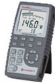
(d) Equipamento de leitura do nível de potência.
