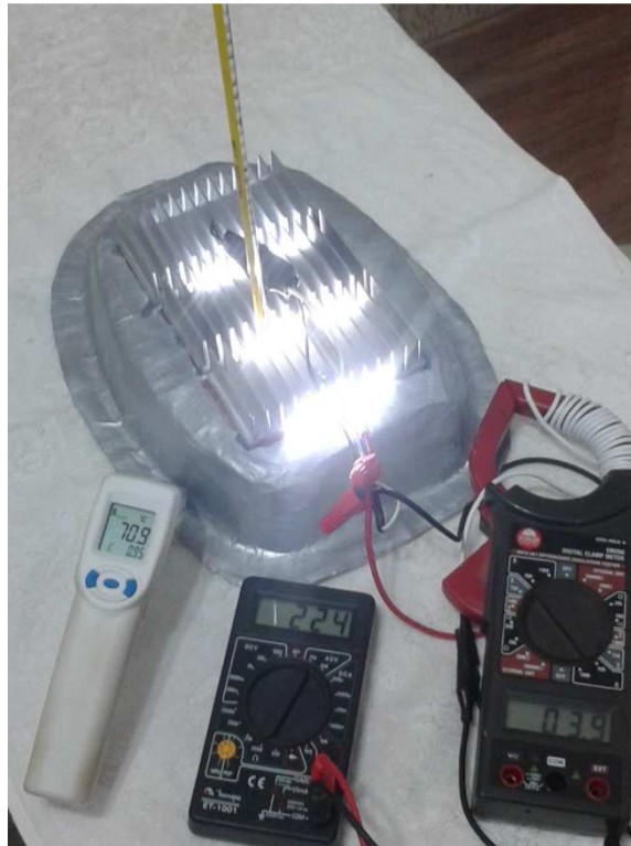
Figura 24 - Ensaio de grandezas elétricas e térmica do módulo de LED Fonte: Autoria própria.
