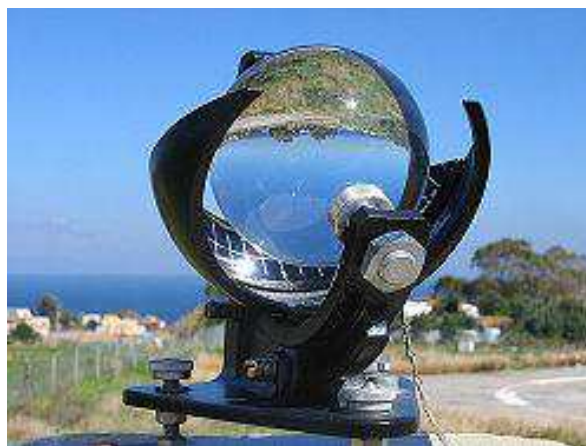
Figura 10 – Exemplo de Heliógrafo Campbell-Stokes. Fonte: CRESESB (2004)
