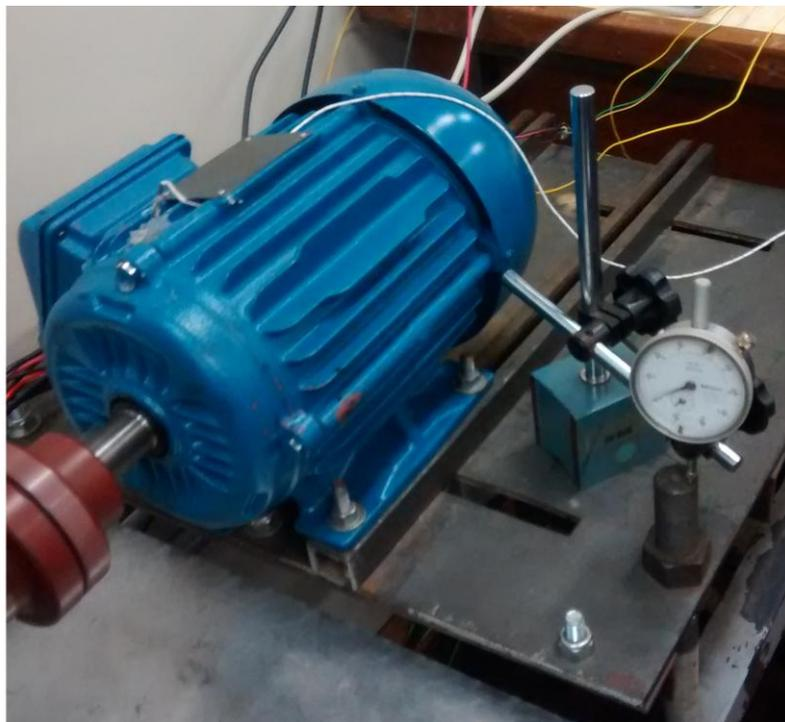
**Figura 36 – Relógio comparador na bancada de teste.**
