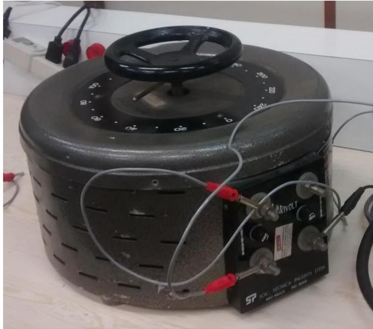
**Figura 32 – Transformador variador de voltagem monofásico.**
