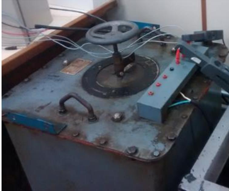
**Figura 20 – Transformador variador de voltagem trifásico.**
