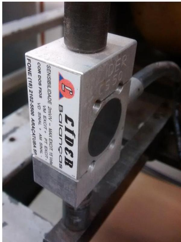
Figura 18 – Célula de carga
