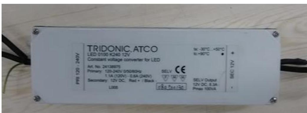
**Figura 17 – Conversor constante de tensão.**
