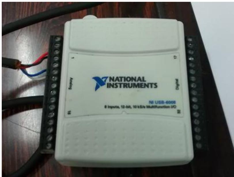
**Figura 15 – NI USB 6008 Módulo de aquisição de dados multifuncional.**
