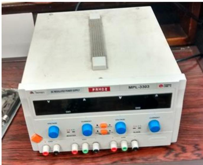
**Figura 22 – Fonte digital de tensão CC.**
