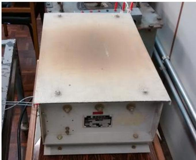
**Figura 21 – Carga resistiva trifásica.**
