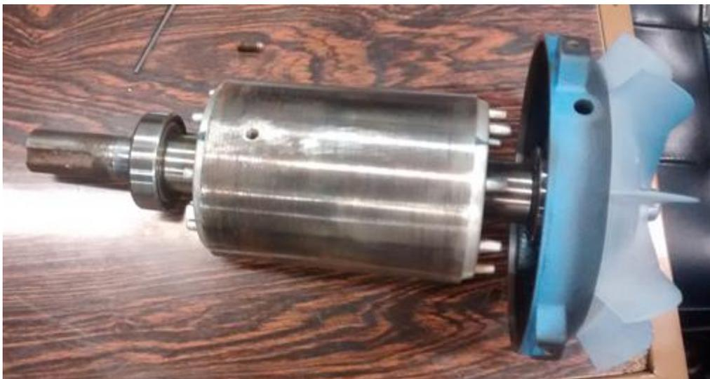
**Figura 34 – Rotor furado, na condição de rotor aberto.**
