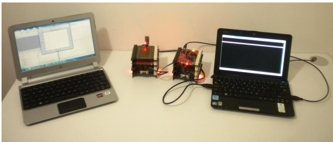
Figura 16: Experimento teste comunicação CAN Fonte: Autoria própria.
