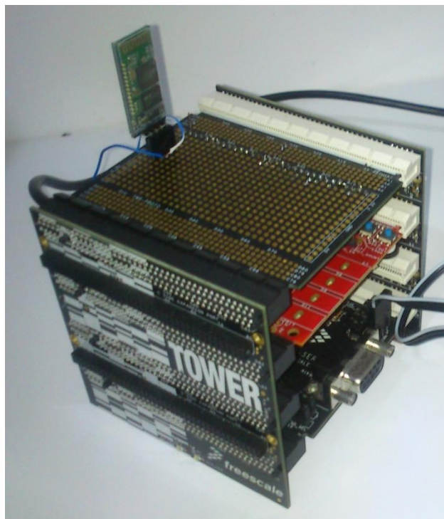
Figura 20: dispositivo módulo CAN Bluetooth Fonte: Autoria própria.
