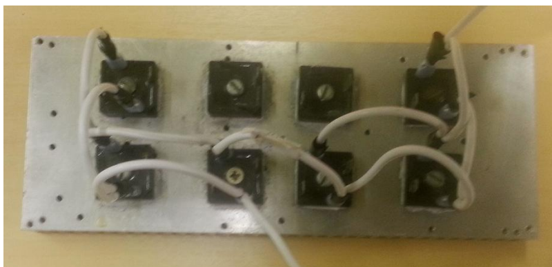
Figura 47 – Ponte retificadora com diodos 36MB140A Fonte: Autoria própria.
