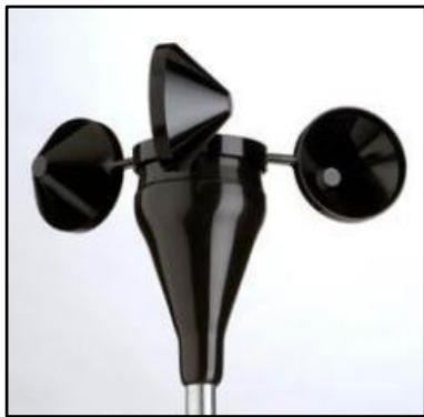
Figura 23 - Anemômetro de Conchas (de Robinson) Fonte: COSTA, 2014.
