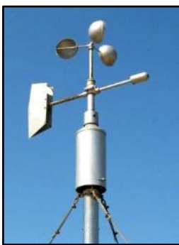
Figura 18 - Anemômetro de Copos (de Robison) Fonte: Como fazer, 2014.
