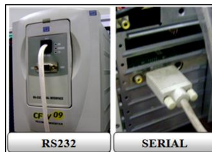
Figura 53 - Conexão Inversor-PC Fonte: Autoria própria
