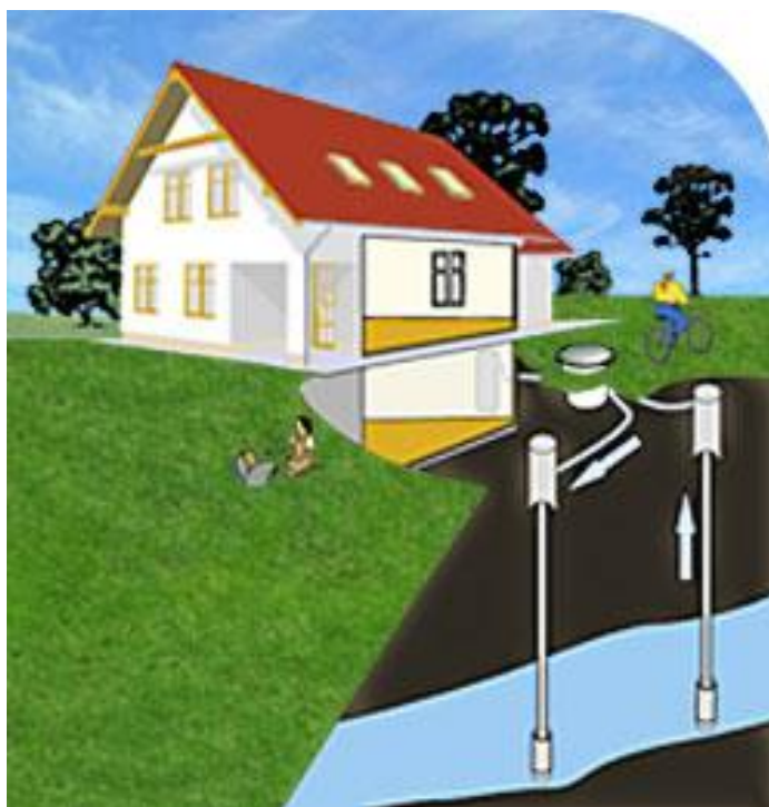
Figura 7 - Bomba de calor em lençol freático.
